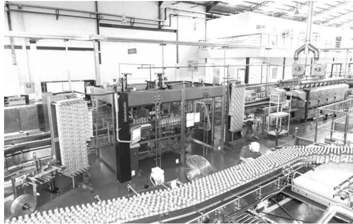
Рис. 3. Компенсатор (накопичувач) в системі транспортування виробів
