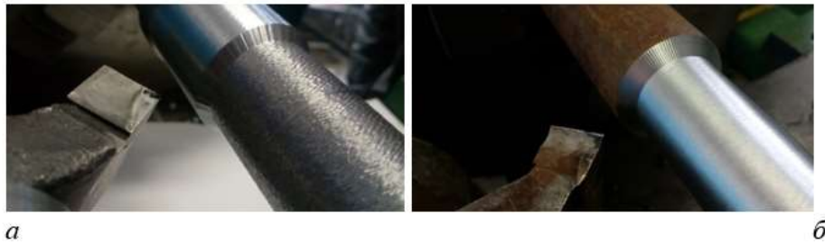
Рисунок 9 – Поверхні деталі, оброблені при: а – розрахованому несталому режимі; б – розрахованому сталому режимі [31]
