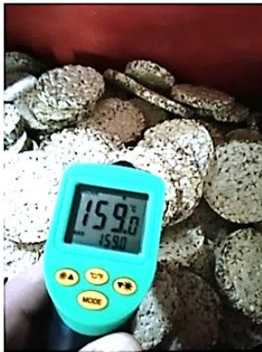
Рис.7,8. Вимірювання температури хлібців відразу після випічки та зняття показів в контрольних точках А, Б, С з нагрівних плит та матриці в процесі виходу на температуру режиму випічки.
