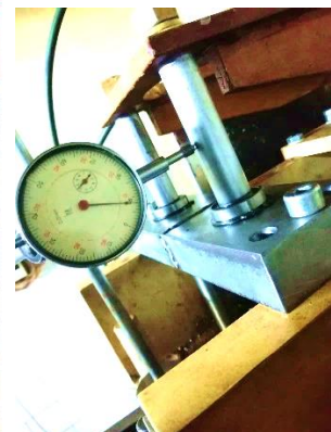
Рис.9. Світлина вимірювання лінійного переміщення формуючого пристрою в зоні напрямних колонок
