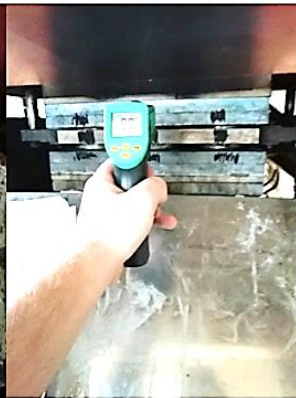
Рис.7,8. Вимірювання температури хлібців відразу після випічки та зняття показів в контрольних точках А, Б, С з нагрівних плит та матриці в процесі виходу на температуру режиму випічки.
