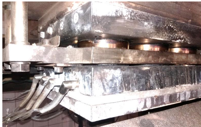
Рис.1. Шестипозиційна матриця з нагрівними пуансонами
