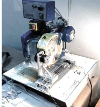
Рис.7. Верстат моделі SKU фірми Avalon (Польща), обладнаний макетом-приставкою автоматичної радіальної подачі кульок
