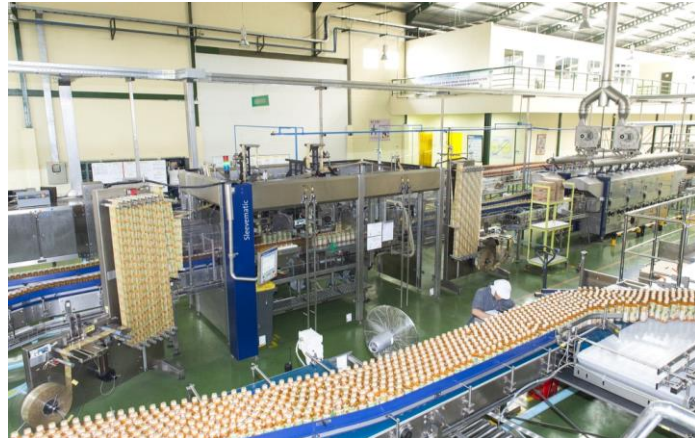
Рис. 3. Компенсатор (накопичувач) в системі транспортування виробів
