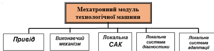
Рис. 9. Структура розвинуеного мехатронного модуля технологічної машини
