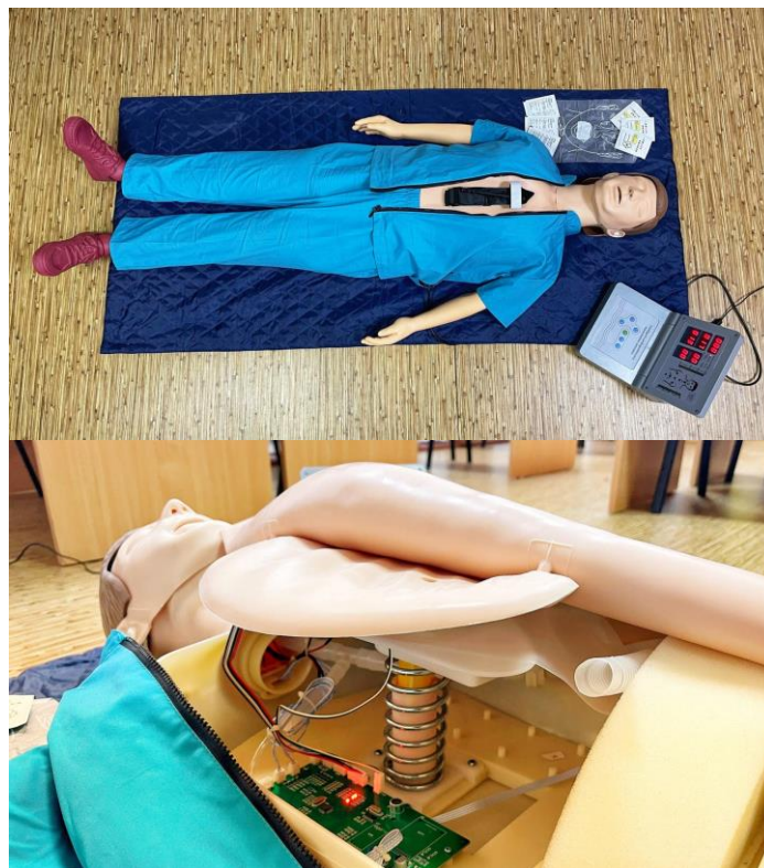
Рис. 1. Комп'ютеризований манекен для контролю навичок надання серцево-легеневої реанімації
