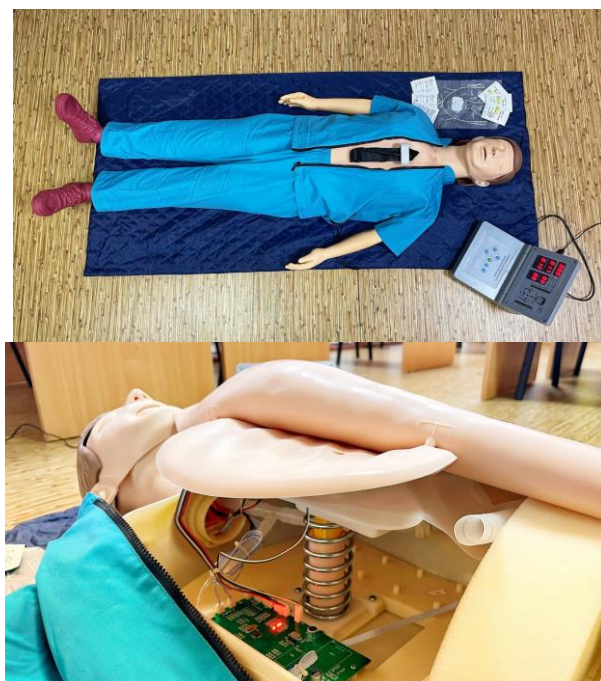
Рис. 1. Комп'ютеризований манекен для контролю навичок надання серцево-легеневої реанімації
