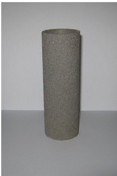
Рис. 3. Зразок двошарового титанового фільтру виготовленого квазіізостатичним пресуванням марки ПТХ-1 методом СВС-спікання
