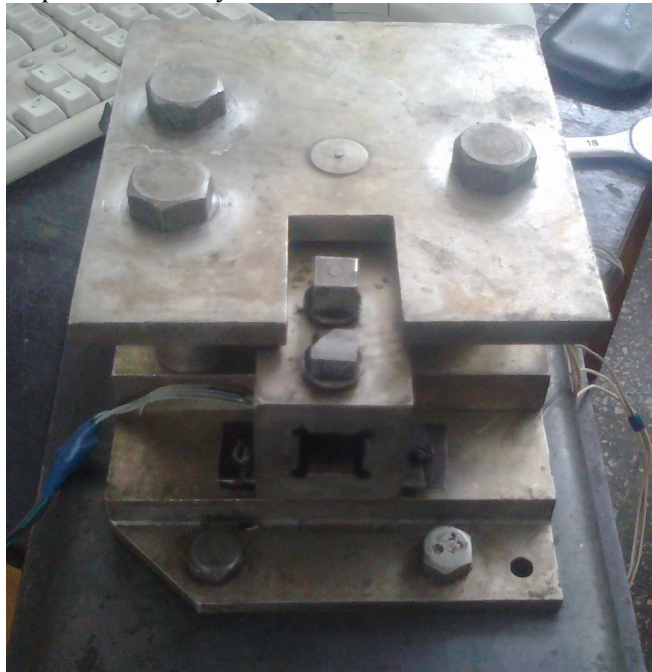
Рис. 2. Трьохкомпонентний динамометр на основі тензодатчиків в зборі
