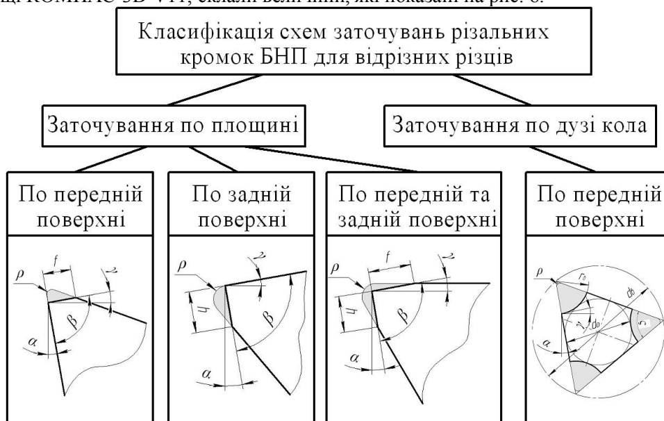
Рис. 7. Класифікація схем заточувань різальних кромки БНП для відрізних різців
