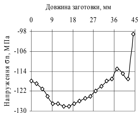
Рис. 10. Розподіл напружень \sigma_n по довжині обтиснутої частини заготовки
