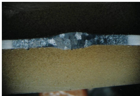
Рис. 3. Макроструктура зварного з'єднання: а – макрознімок; б – схема
