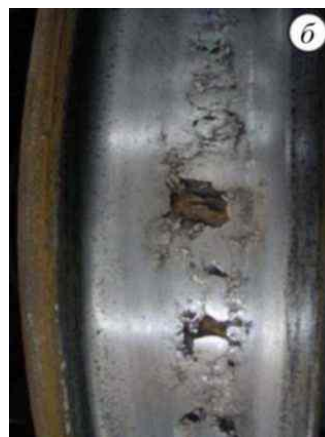
Рис. 2. Експлуатаційні пошкодження на поверхні кочення коліс: а) повзуни, б) вищербини, а також порівняння відносної кількості ( n ) коліс КП-2 (□) і КП-Т (▨) випуску 2005-2008 рр. з цими пошкодженнями (в)
