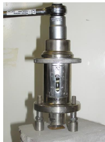
Рис. 9. Конструктивна схема адгезиметра «АДГМ 20-Техно-Ресурс» (зліва) і відрив грибка від поверхні бетонного зразка (справа): 1 – гайка; 2 – барабан; 3 – вальниця; 4 – шпіндель; 5 – пружина; 6 – втулка центрувальна; 7 – корпус; 8 – демпфер; 9 – захоплювач; 10 – грибок; 11 – ніжки; 12 – втулки; 13 – гвинти; 14 – шпонка; 15 – кільце; 16 – фіксатор; 17 – лінійна шкала; 18 – бобіна; 19 – лімбава шкала
