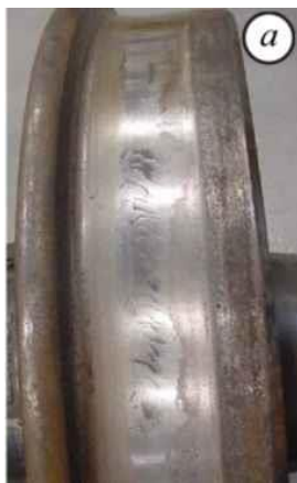
Рис. 2. Експлуатаційні пошкодження на поверхні кочення коліс: а) повзуни, б) вищербини, а також порівняння відносної кількості ( n ) коліс КП-2 (□) і КП-Т (▨) випуску 2005-2008 рр. з цими пошкодженнями (в)
