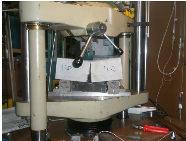
Рис. 8. Руйнування залізобетонного зразка з концентратором напружень в зоні сталевій арматури за навантаження згином
