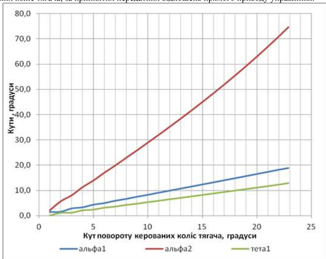
Рис. 3. Графік залежності кутів складання автопоїзда від кута повороту керованих коліс автомобіля-тягача.
