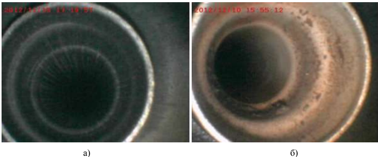
Фото 1. Состояние поверхности трубок радиатора автомобиля ВАЗ-2115: а – новый радиатор; б – после замены антифриза
