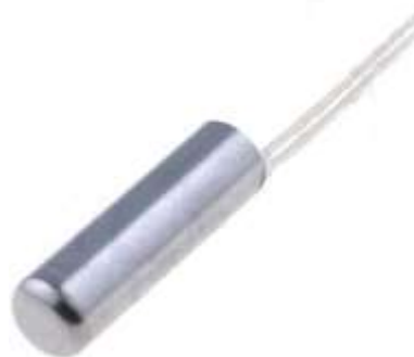
Рис. 3. Зовнішній вигляд платинового терморезистора RT100-20X6-2M. ©Г.С.Гудз, М. В. Глобчак, О.Й.Коцюмбас, О.Р.Клипка
