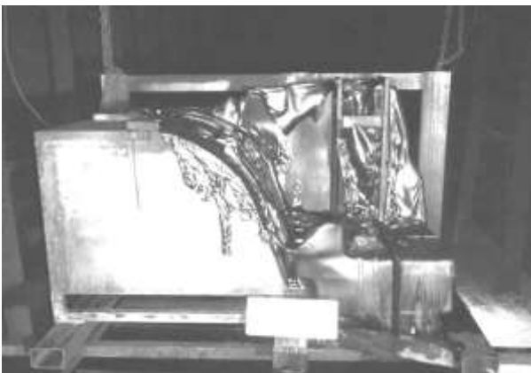
Рис. 6 Бак после испытаний на огнестойкость
