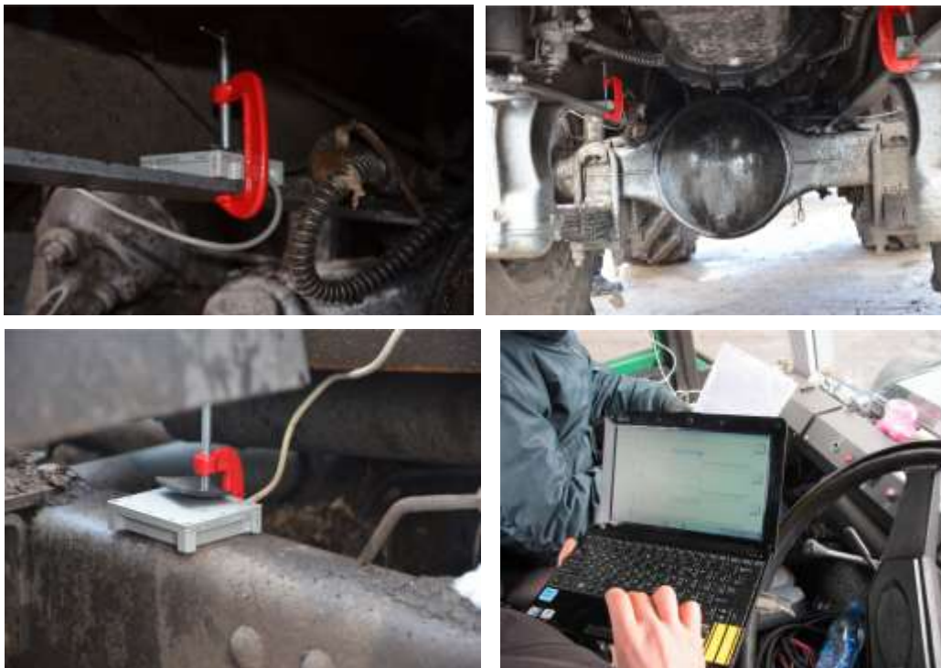
Рис. 4. Встановлення і налаштування мобільного вимірювального комплексу на тракторі ХТА-200 «Слобожанець»
