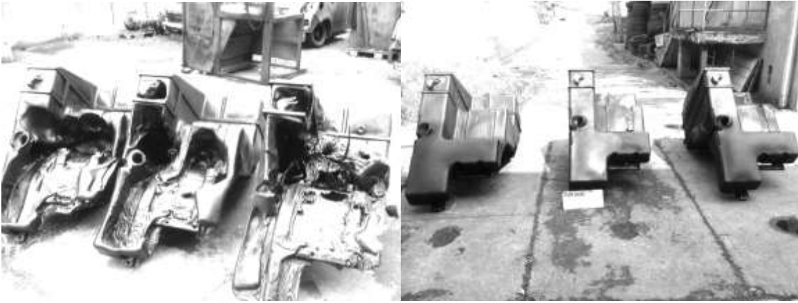
Рис. 14 и 15 Сравнение результатов испытаний бака из материала „PLASTENE R205“ и „REVOLVE XL400“
