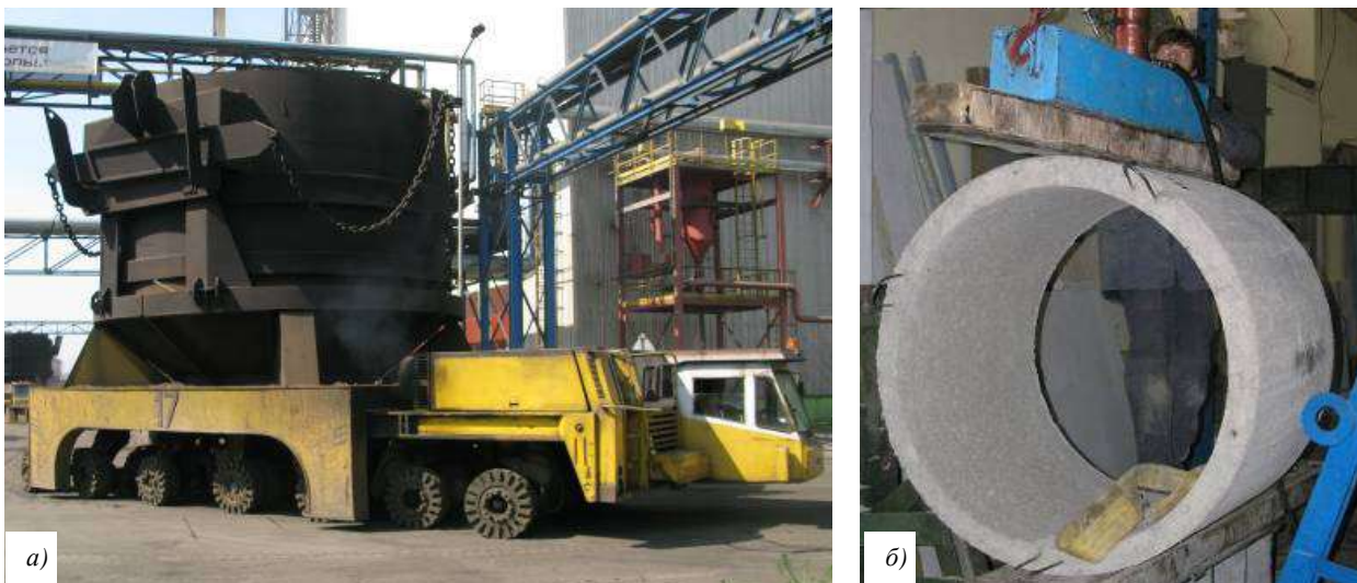
Рис. 2. а) загальний вигляд технологічного транспорту РУП БМЗ з навантаженням на вісь до 150 кН і монолітних плит технологічної дороги в м. Жлобин; б) підготовка до випробування СФБ кільця марки КС10-9.
