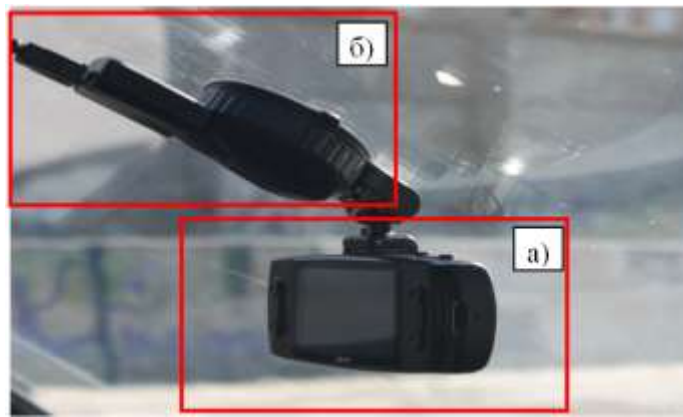
Рис. 2. Складові частини вимірювально-реєструючого приладу TEXET DVR-3GP: а) вимірювально-записуюча частина; б) знімний GPS-приймач;
