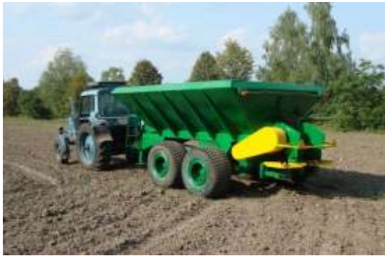
Рис.2.Тракторний транспортно – технологічний напівпричіпний агрегат: а-машина МРД-8; б- машина МРД-4.
