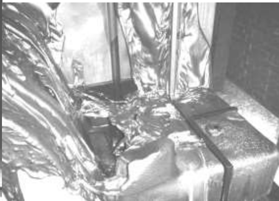
Рис.7 Бак после испытаний на огнестойкость
