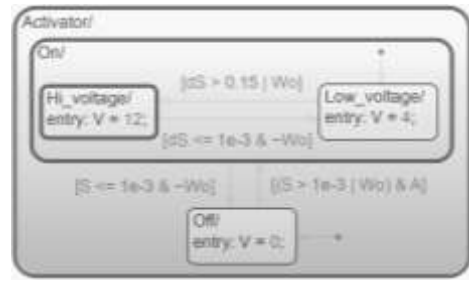
Рис. 5. Структурна Stateflow модель логічного контролера (рис. 4, поз. 9).
