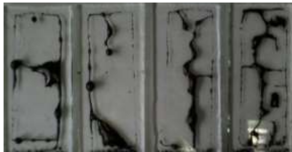
Рис. 1. Скляні пластини після випробування бітуму марки БНД 60/90
