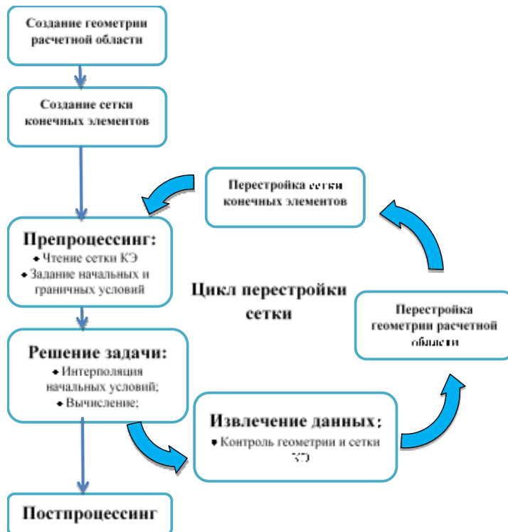
Рис. 6. Интеграция цикла перестройки сетки КЭ в общий цикл решения задачи
