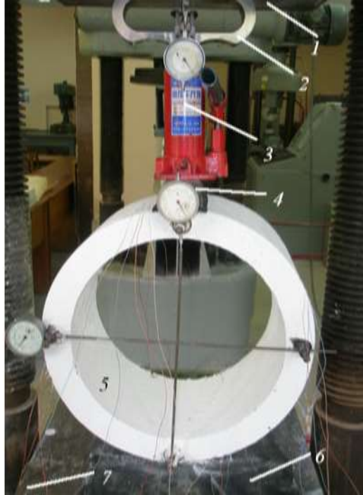
Рис. 3. Загальний вигляд випробування елементів кільцевого перерізу: 1 – верхня опорна плита пресу ПСУ-125; 2 – зразковий динамометр; 3 – домкрат; 4 – металева траверса; 5 – дослідний зразок кільцевого перерізу; 6 – гумовий килим; 7 – нижня опорна плита пресу ПСУ-125.
