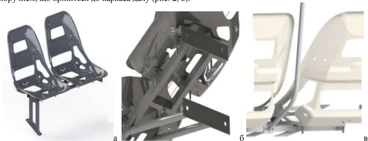
Рис. 2. Тривимірна модель сидіння з основою на стійці (а), консольною конструкцією кріплення до боковини автобуса (б), з поручнем (в)
