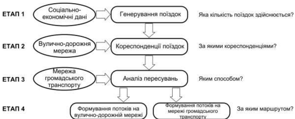
Рис. 1. Структурна схема процесу вивчення попиту на перевезення пасажирів
