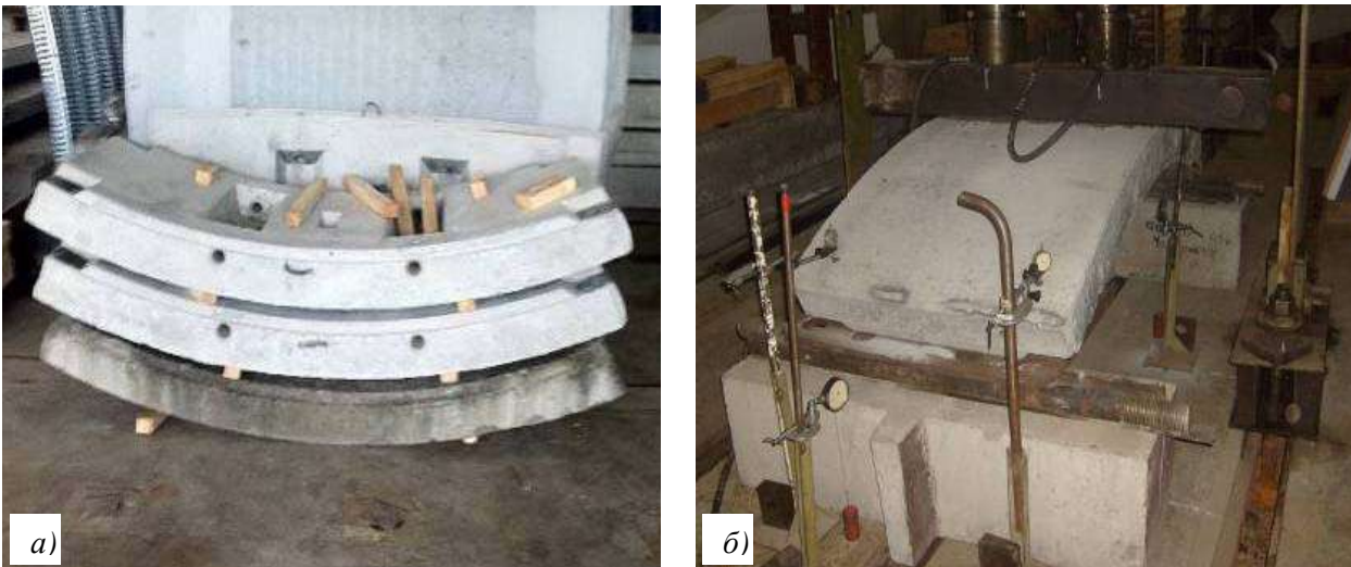
Рис. 1. а) виготовлені експериментальні тюбінги марки 55Р.Н.СФ; б) дослідження експериментальної конструкції тюбінгу 55Р.Н.СФ.
