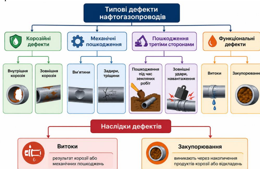
Рис. 2. Класифікація дефектів трубопроводів
