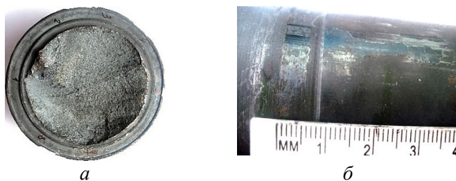
Рис. 1. Загальний вигляд поверхні зламу штока регулювального клапана (а) та сліди контактного зношування на бічній його поверхні (б).
