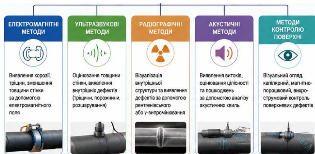
Рис. 3. Методи неруйнівного контролю трубопроводів
