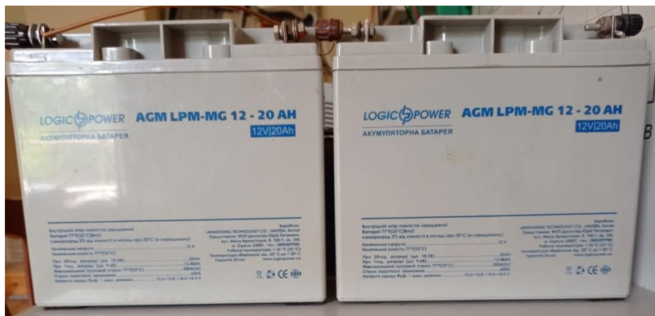
Рис. 11. Батарея з двох акумуляторів для прикладання зовнішньої напруги до фотомодуля
