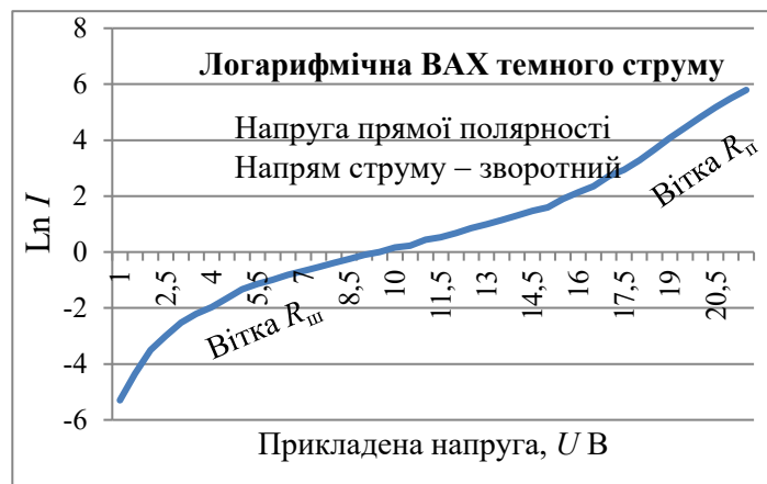
Рис. 18. Темнова ВАХ фотомодуля від прикладеної напруги прямої полярності
