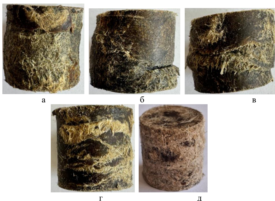
Рис. 7. Вигляд біокомпозитних зразків складу № 3 із ступенем підсушування композиції 5% (а), 10% (б), 15% (в), 20% (г), 25% (е) після руйнування
