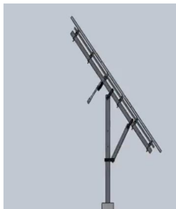
Рис. 9. Конструкція опорної системи для встановлення сонячної панелі з можливістю регулювання кута нахилу.
