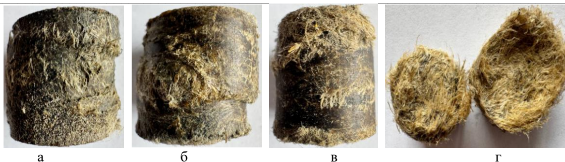
Рис. 8. Вигляд біокомпозитних зразків складу № 4 із ступенем підсушування композиції 5% (а), 10% (б), 15% (в), 20% (г), 25% (е) після руйнування
