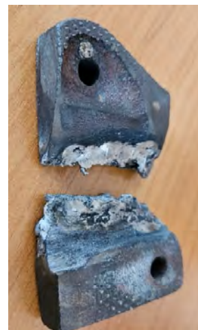
Рис. 6. Один із дослідних зразків після випробувань на розтяг із характером руйнування
