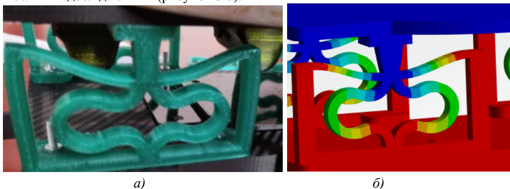
Рис. 9. а) деформація КНЖ-елементів із ТПУ і раптове опускання верхньої платформи під час переходу до зони КНЖ; б) деформований стан платформи на моменті виходу з зони КНЖ
