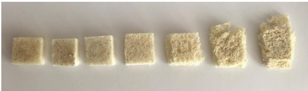
Рис. 3. Зовнішній вигляд стиснених зразків ППУ, модифікованих силіконом
