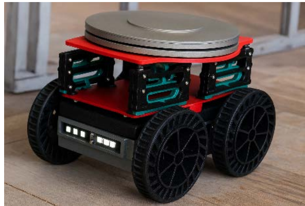
Рис. 6. Роздрукований ровер під час тестів: корпус із ПЕТГ і КНЖ-елементи з ТПУ
