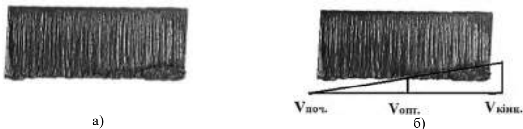
Рис. 2. Запропонована методика визначення оптимальної швидкості ГЛР металевого листа заданої товщини: заготовка, при різанні зі змінною швидкістю (а), ця ж заготовка з графіком зміни швидкості ГЛР (б)
