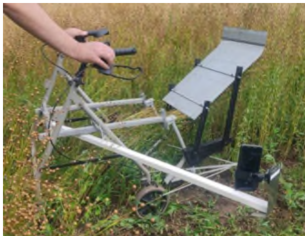
Рис. 2 – Фото експериментальної установки нахилювача стебел льону
