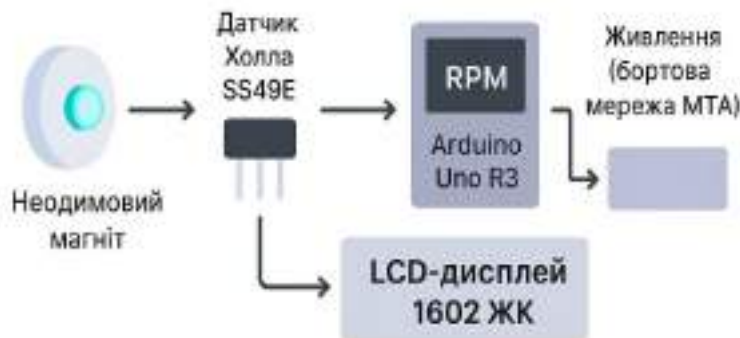
Рис.1. Структурно-функціональна схема тахометра
