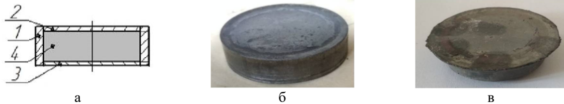
Рис. 2. Схематичне зображення вихідної заготовки (а), а також зразок до (б) та після деформування (в): 1 – сталеві обойми, 2 – верхня кришка; 3 – нижня кришка; 4 – досліджуваний матеріал
