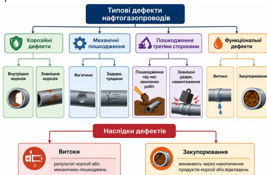
Рис. 2. Класифікація дефектів трубопроводів
