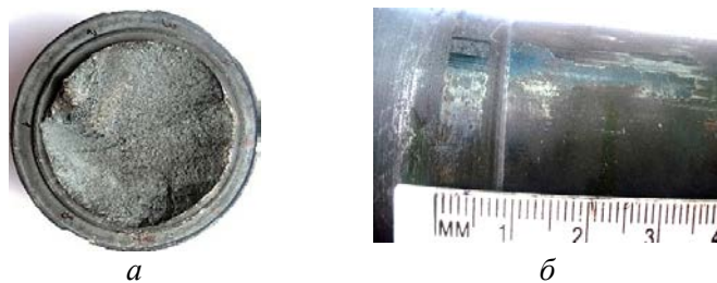
Рис. 1. Загальний вигляд поверхні зламу штока регулювального клапана (а) та сліди контактного зношування на бічній його поверхні (б).
