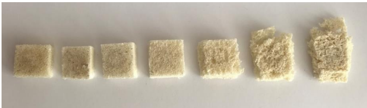
Рис. 3. Зовнішній вигляд стиснених зразків ППУ, модифікованих силіконом
