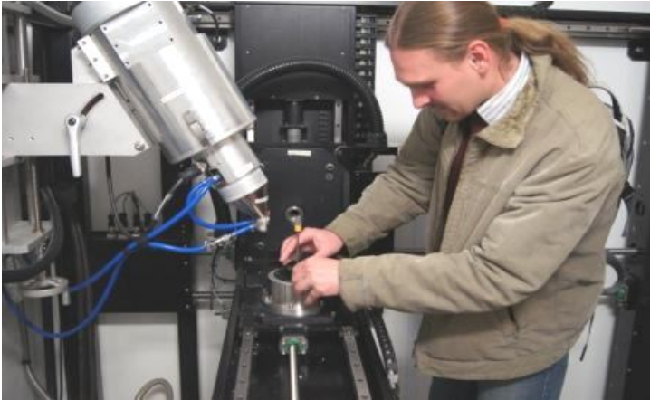
Рис. 8. Проведення експерименту на електронно-скануючому мікроскопі X-ТЕК 225/320 kV СТ SPECIAL
