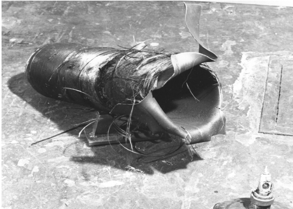
Рис. 8. Характер руйнування балонів з початковим тиском газу 19,6 МПа, які розташовувались вертикально над поверхнею дизельного пального
