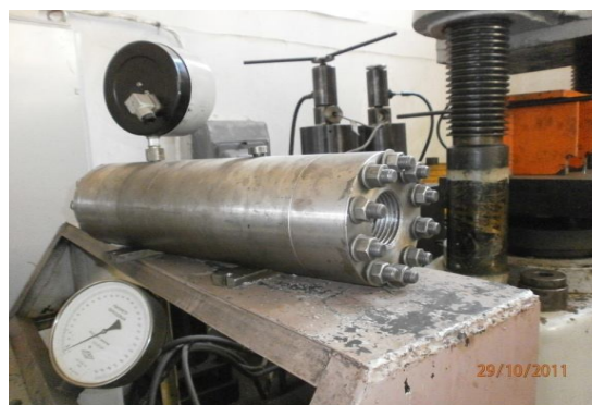
Рис. 1. Схема конструкції (а) та загальний вид (б) прес-блоку напівпромислової установки для СР-Ш в замкнутому об'ємі:
