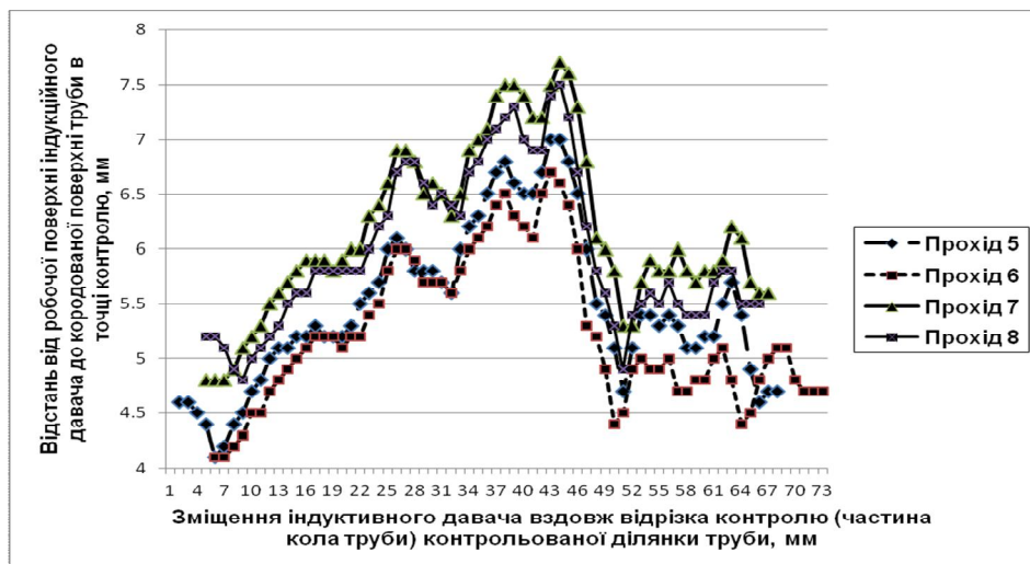
Рис. 6. Графіки зміни відстані між робочою поверхнею індуктивного давача та кородованою поверхнею металу труби на контрольованій ділянці при почерговому виконанні проходів вздовж ділянки зі зміщенням між проходами 2 мм
