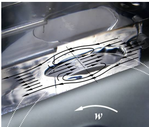
Рис. 2. Линии тока смазочной среды (а) и трибокавитация (б), наблюдаемые в динамике при трении на лабораторном приборе АСБ-01 с оптическим каналом съема информации
