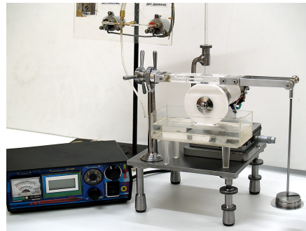
Рис. 1. Схема (а) и внешний вид (б) машины трения скольжения АСБ-01 с физически прозрачной трибосистемой
