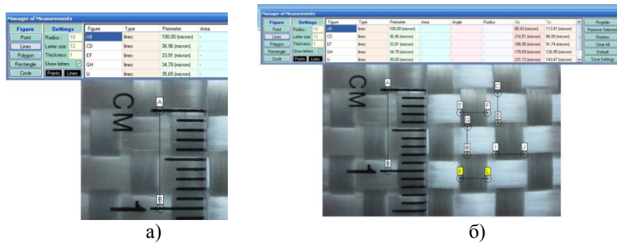
Рис. 5. Тарувальний відрізок (а) і вимірювання відстаней (б) на текстильному армуючому матеріалі
