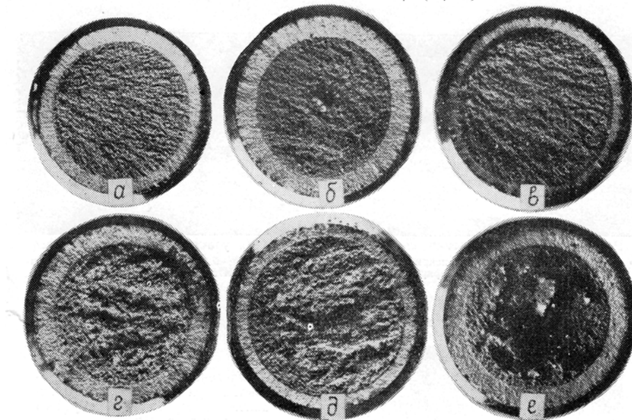
Рис. 2. Зломи циліндричних зразків з попередньо наведеними втомними тріщинами, зруйновані з метою оцінки K_{IC}
