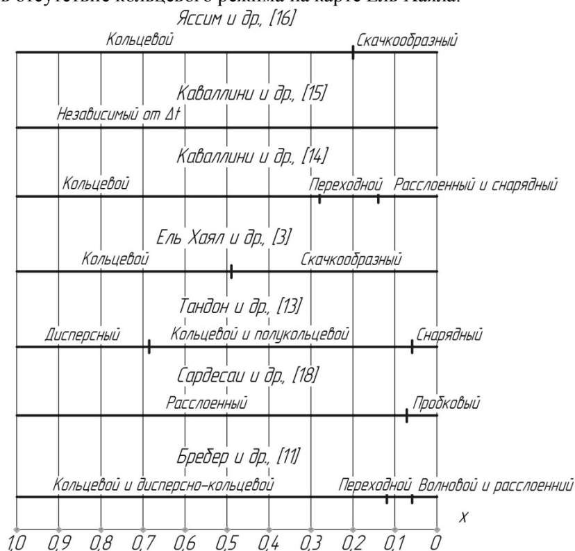
Рис. 6. Сравнение современных карт режимов при конденсации пропана с t_k=40\text{ }^\circ\text{C} в трубе d=8,8\text{ мм} при массовом расходе G=300\text{ кг/(м}^2\cdot\text{с)}
