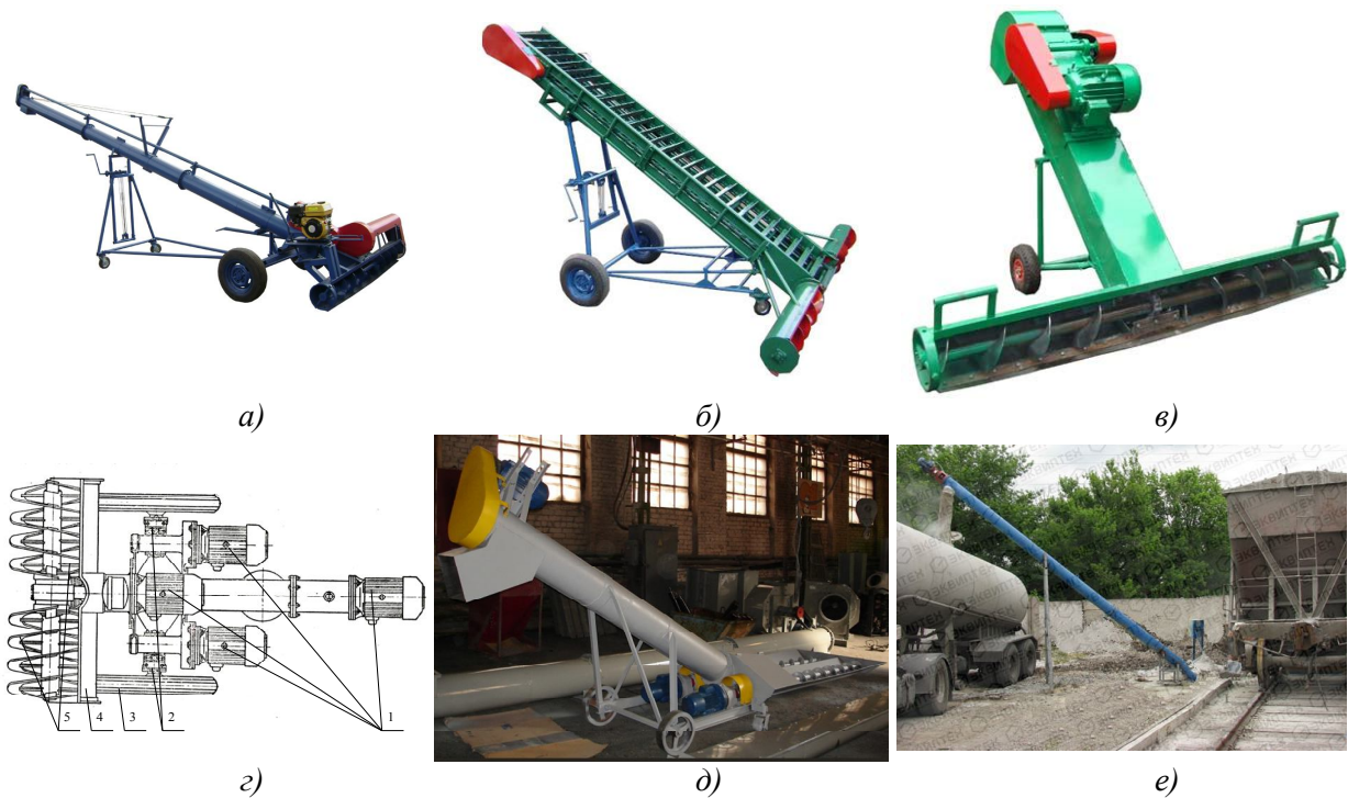
Рис. 3. Завантажувальні пристрої: а) завантажувач шнековий (ООО «Гарант-Агро», м. Кривий Ріг, http://garantagro.com ); б) скребково-шнековий транспортер (ООО «Гарант-Агро», м. Кривий Ріг, http://garantagro.com ); в) шнек підбору з землі зернових і технічних культур у вигляді приставки для завантаження транспортерів шнекових, стрічкових, норій (ООО «Гарант-Агро», м. Кривий Ріг, http://garantagro.com ); г) шнековий забірний візок [2]; д) гвинтовий розвантажувач вагонів (хоппер) У9-РХ-61 в роботі (ПАТ «ЕКВІПТЕХ» м. Дніпропетровськ, www.ekvipteh.com.ua ); е) гвинтовий розвантажувач вагонів У9-РХ-61 в роботі
