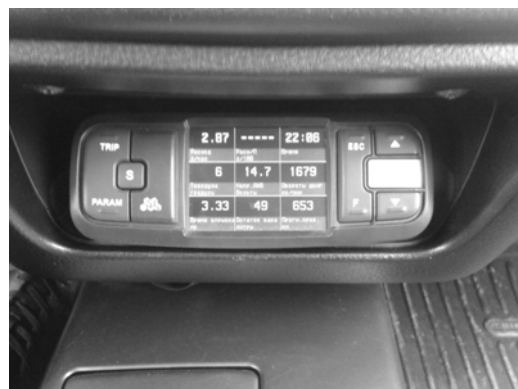
Рис. 3. Бортовий комп'ютер Multitronics TC 750
