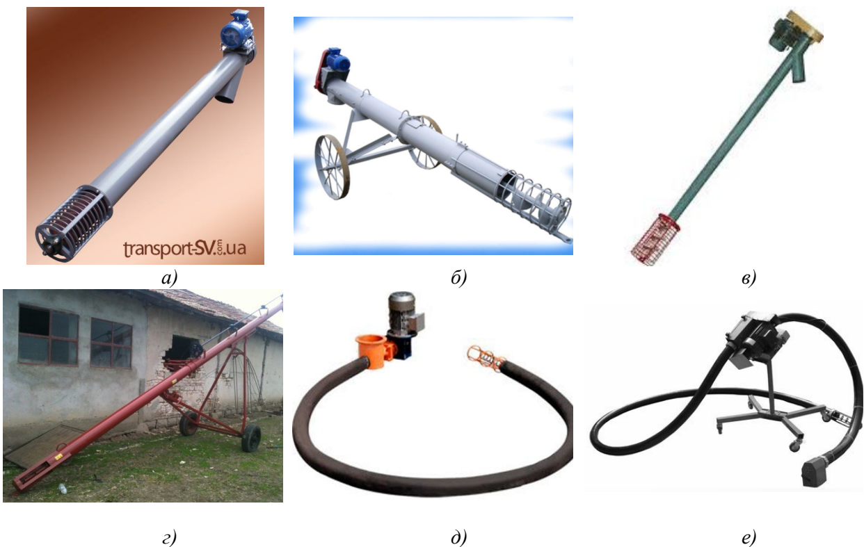
Рис. 2. Гвинтові конвеєри із завантаженням через насадки: а) (ПАТ «Завод елеваторного обладнання», м. Кіровоград, http://transport-sv.com.ua ); б) (ООО «Промстройкомплект» Росія, http://promstrojkomplekt.all.biz ); в) (ООО «Флона», Білорусія, http://www.flona.by ); г) (ЕТ «КИСИ-Иван Маринов», Болгарія, http://prodajba.net ); д) (ООО «ТехРесурс», Росія, http://www.tehresurs-altay.ru ); е) (ООО ТД «БМЗ», Росія, http://shneka.ru )
