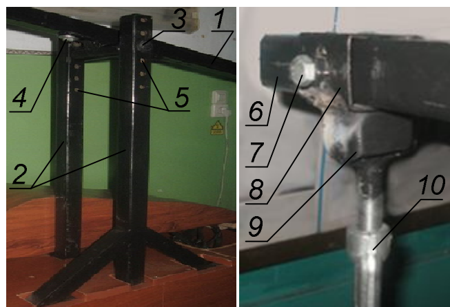
Рис. 3. Елементи кріплення та регулювання положення осі коромисла і довжини шатуна:
