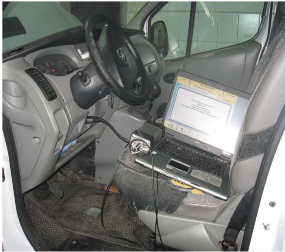
Рис. 1. Підключення діагностичного сканера "RENAULT CAN Clip"
