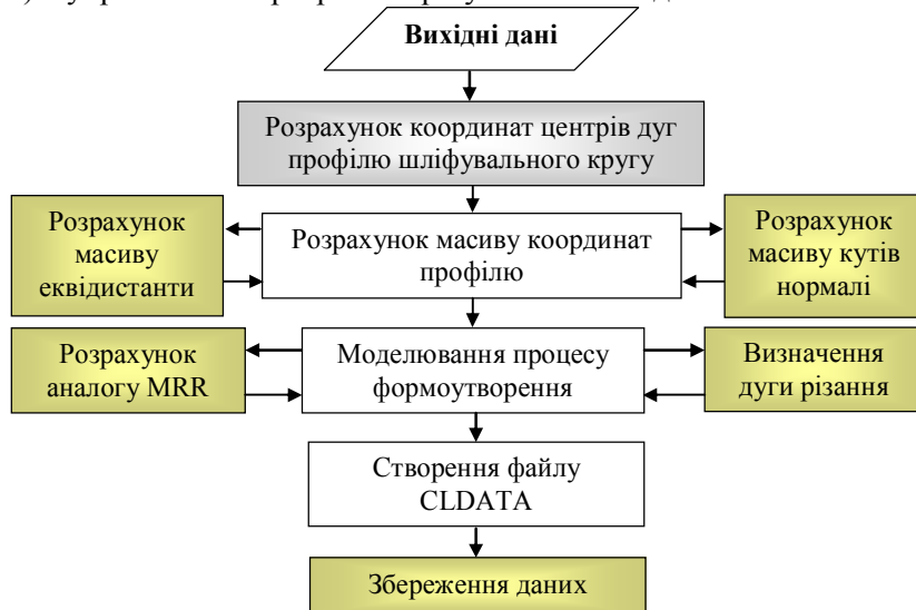
Рис.6. Укрупнена блок-схема алгоритму моделювання
