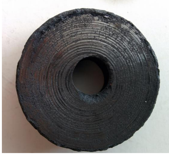
Рис.6. – Зразок №2 після точіння торця
