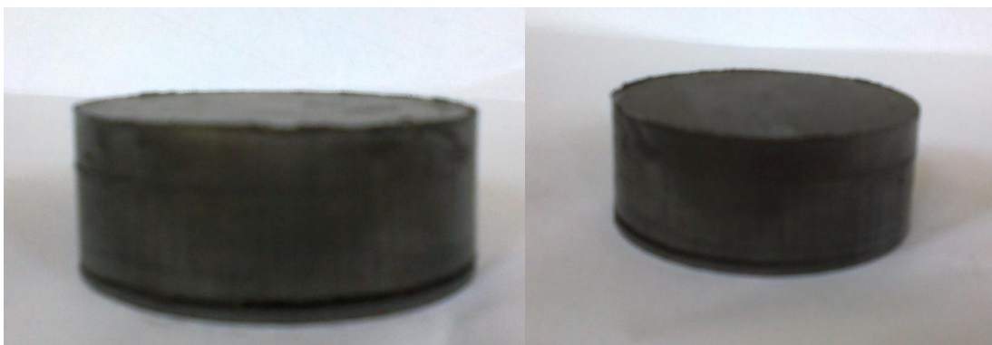
Рис.3. – Порошок після пресування
