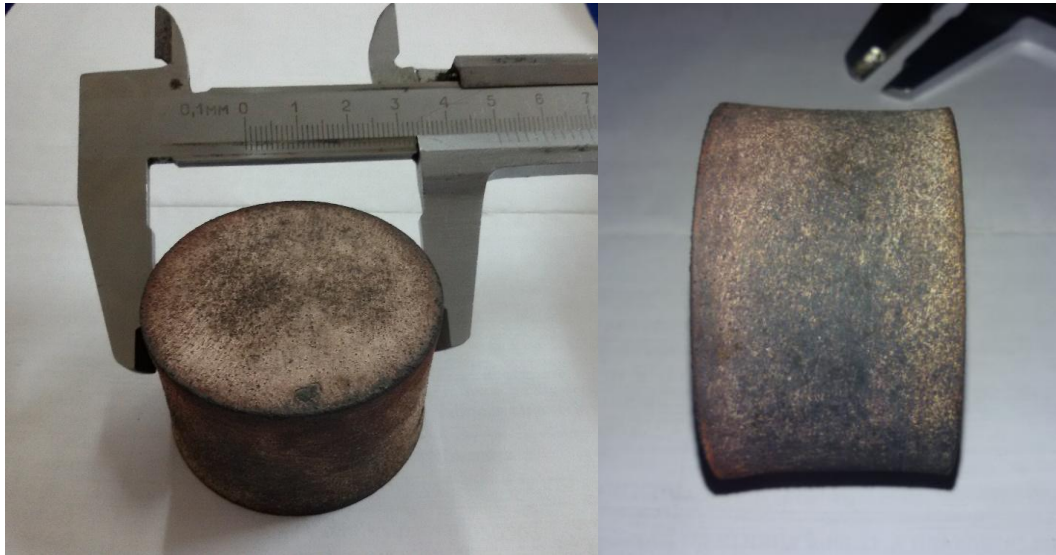
Рис.9. – Зразок № 3 після спікання
