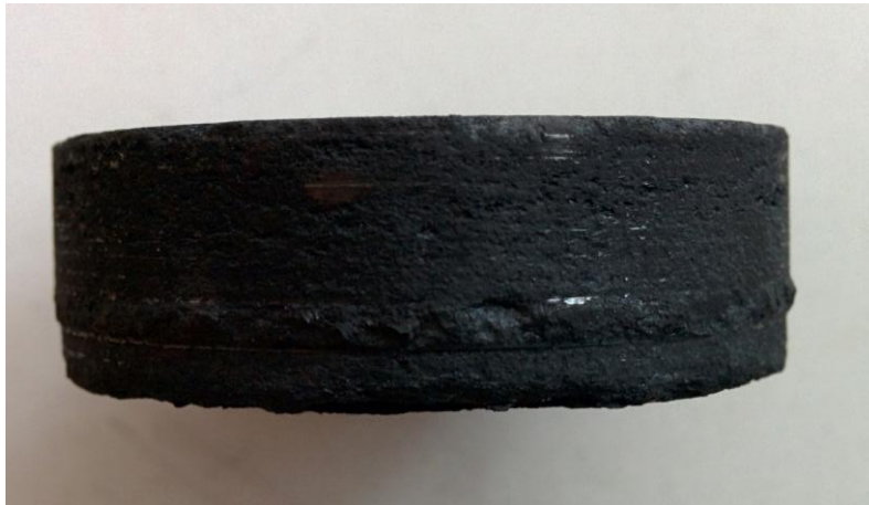
Рис.7. – Зразок № 2 після точіння циліндричної поверхні
