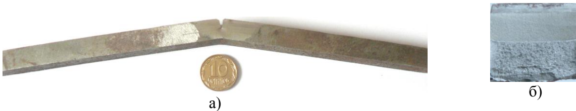
Рис. 3. - Загальний вигляд зразка (а) та площі деформованої поверхні зразка (б) після експерименту з дослідження умов спонтанного руйнування тривало експлуатованих буриньних труб
