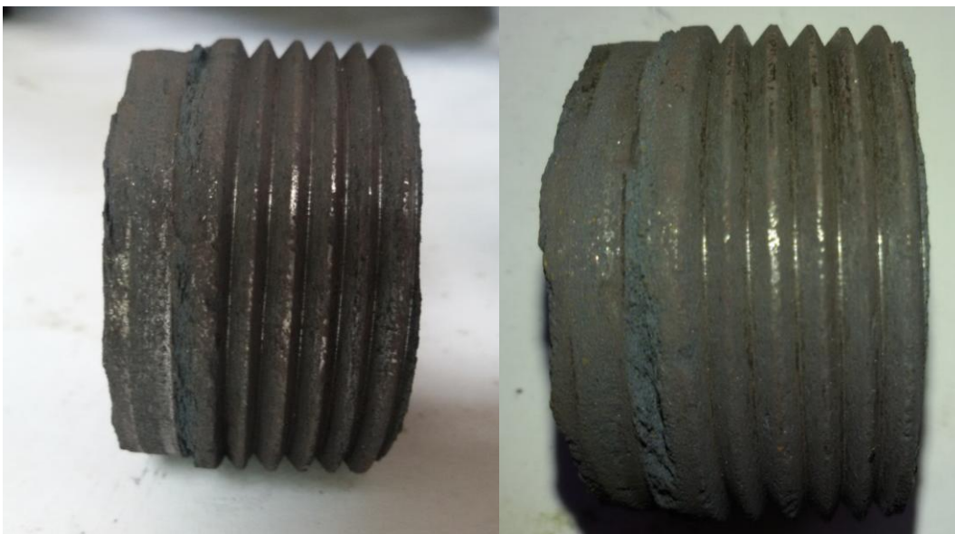
Рис.10. – Зразок № 3 після нарізування різі
