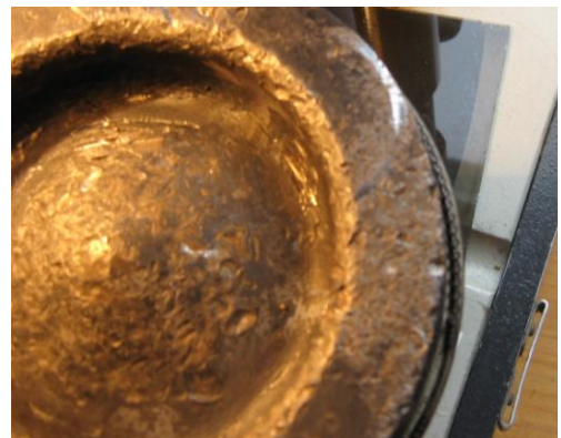
Рис. 13. Слід схоплювання поршня з клапаном
