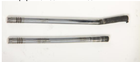
Рис.2. Загальний вигляд пошкоджених клапанів. Стрижні без тарілки.
