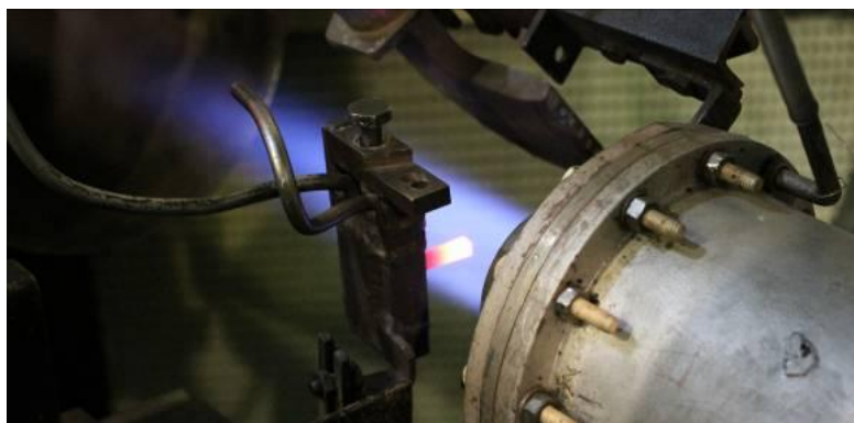
Рис.4. Зовнішній вигляд випробувань на термоциклювання в полум'ї вогнемету.
