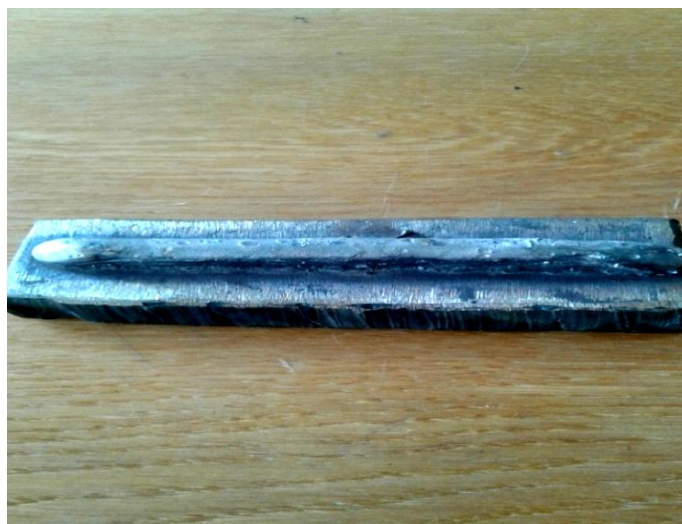
Рис. 1. Загальний вигляд 3-х шарової наплавки сформованої з використанням порошкового дроту з наповнювачем на основі порошкового заліза та розроблених композиційних порошків
