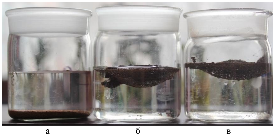
Рис. 5. Змочування водою зразків природного сапоніту (а), модифікованого ПДМС (б) та ПС (в)
