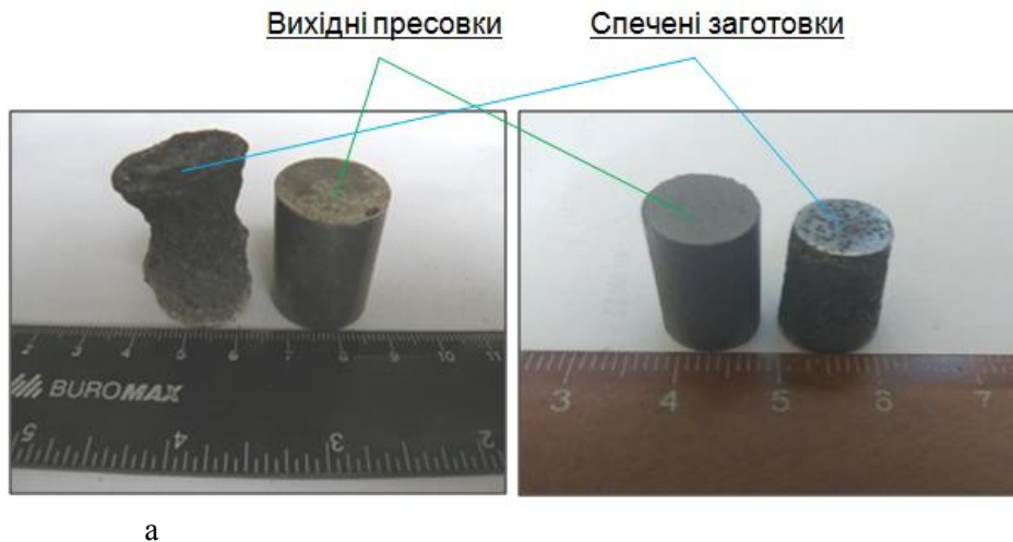
Рис. 2. Зовнішній вигляд пресованого та спеченого зразка після реакційного синтезу при 1250^{\circ}\text{C} для брикетів, отриманих із шихти: а – 30 % FeSiMn – 65 % TiH 2 – 5 % C; б – 30 % FeSiMn – 65 % TiH 2 – 5 % B 4 C
