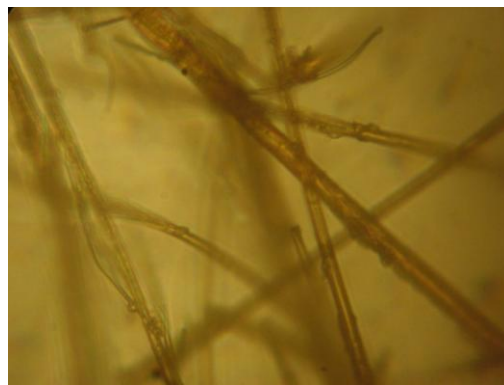
Рис. 8 – Морфологія базальтових волокон після термообробки при температурі (700-900) °С
