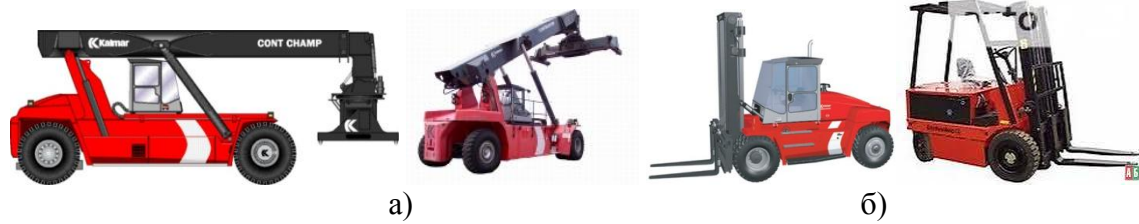
Рис. 1. Автонавантажувачі: а) – з висувною крановою стрілою; б) – з фронтальним вилковим вантажозахватом
