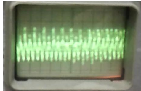
Рис. 6 б Типовий вигляд осцилограми електромагнітного поля при точінні парамагнітної сталі
