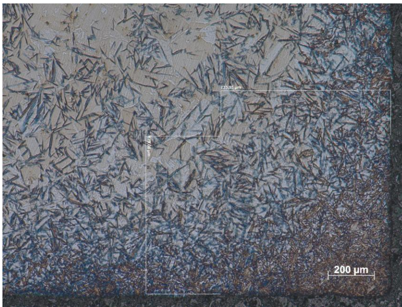
Рис. 1. - Структура приповерхностной области стали 120Г3С2 после закалки от 1000 °С. Выдержка при температуре нагрева 30 минут
