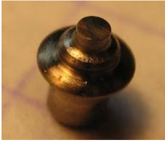
а) Рис. 8 – Кавітаційний знос (а) та промиви запірною конуса (б)
