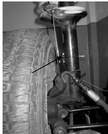
Рис. 7 – До вимірювання швидкості обертання колеса
