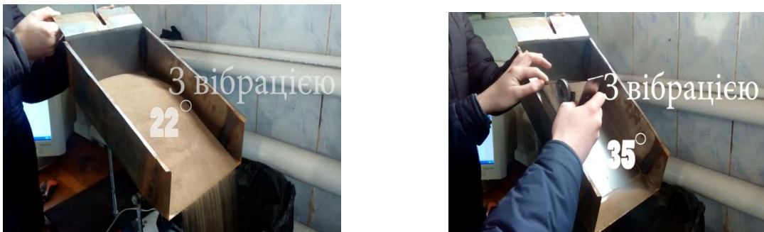
Рис.7.2. Положення моделі кузова на початку (а) і наприкінці розвантажування (б)
