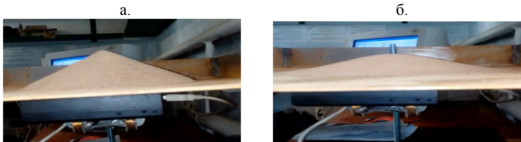
Рис.4. Загальний вигляд вільно насипаного конусу до (а) і після(б) дії вібрацій
