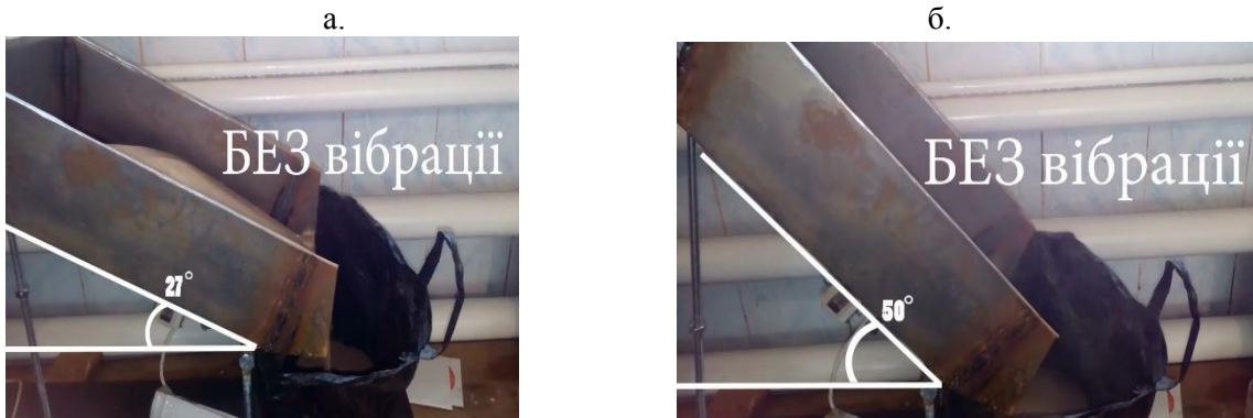
Рис.7.1. Положення моделі кузова на початку (а) і наприкінці розвантажування (б)
