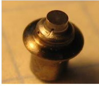
а) Рис. 8 – Кавітаційний знос (а) та промиви запірною конуса (б)
