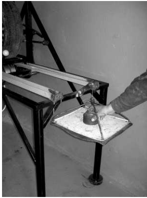
Рис. 3 – Навантаження платформи у початковому положенні стола
