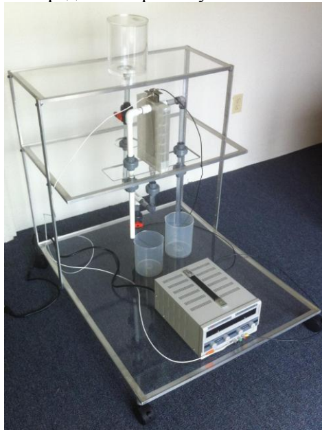
Рис. 5. Фотография системы для реальной корректировки кислотности и щёлочности в деионизированной воде
