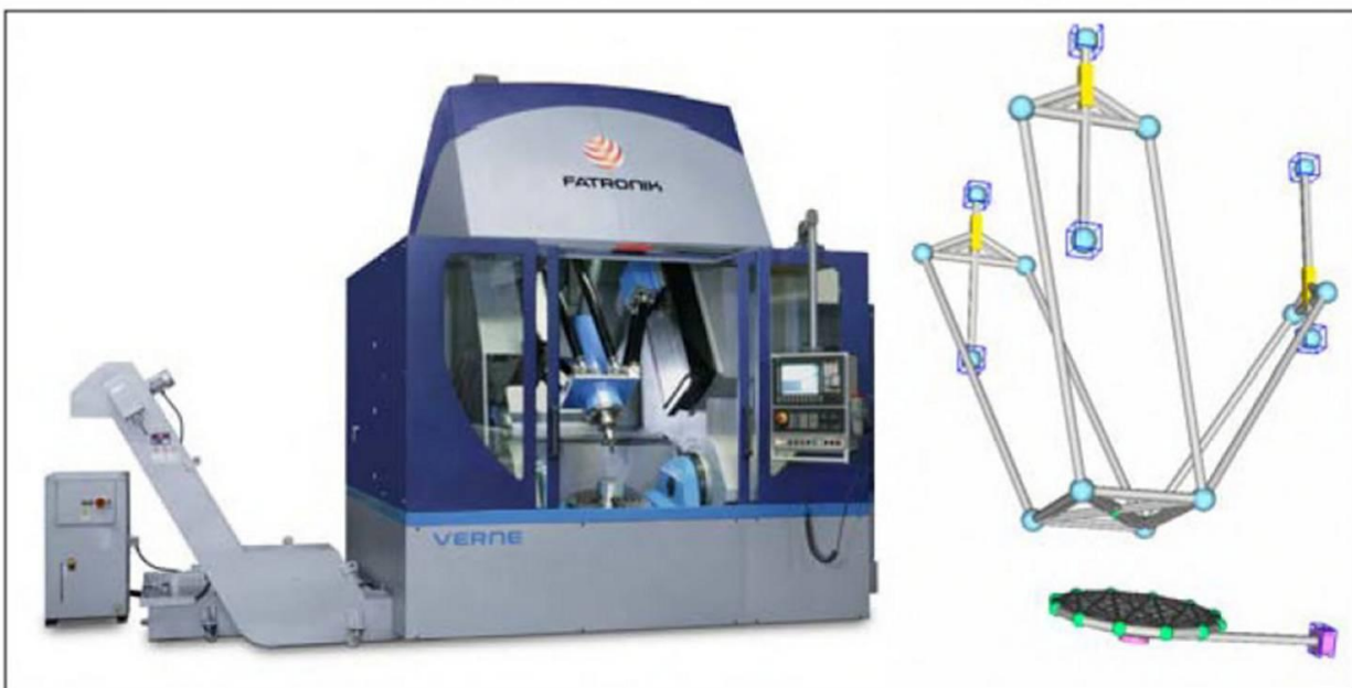
Рис. 4. Обрабатывающий центр Verne (Fatronik) и кинематическая схема
