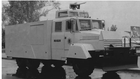
Рис. 1. Водометна спецмашина АВС-30 на шасі КраЗ-63221
