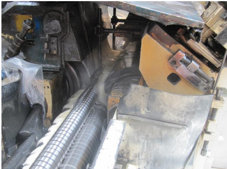
Рис.5. Робочий простір безцентрово-шліфувального верстата
