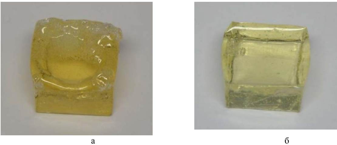
Рис. 1. Загальний вигляд зразків епоксиполімерів без охолодження між циклами (а) та неповним охолодження (б)
