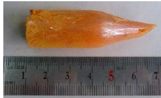
Рис. 3. Зовнішній вигляд монокристала PbI_2 , одержаного з розплаву
