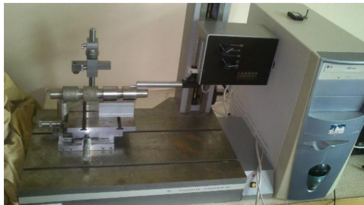
Рис. 2. Измерение шероховатости на приборе профилографе – профилометре мод. 201 завода «Калибр».
