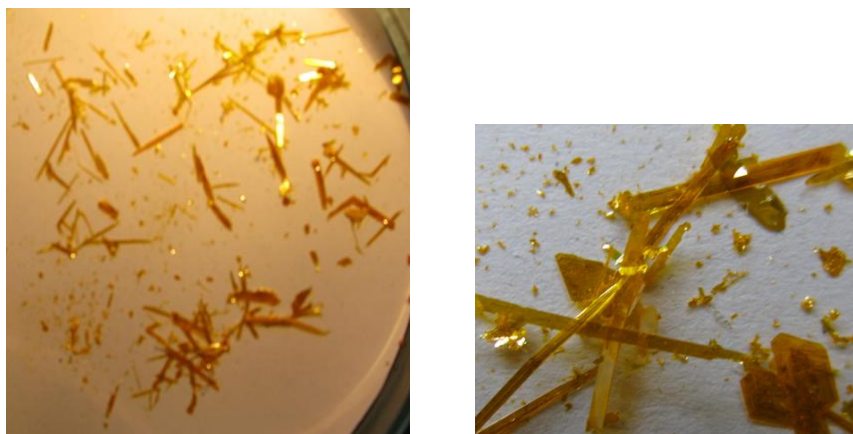
Рис. 1. Зовнішній вигляд монокристалів PbI_2 , одержаних з парової фази
