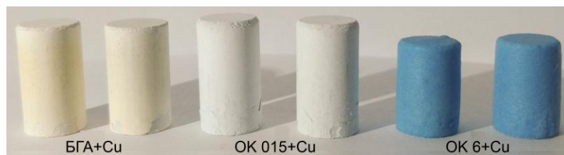
Рис. 1. Зовнішній вигляд зразків кераміки на основі БГА
