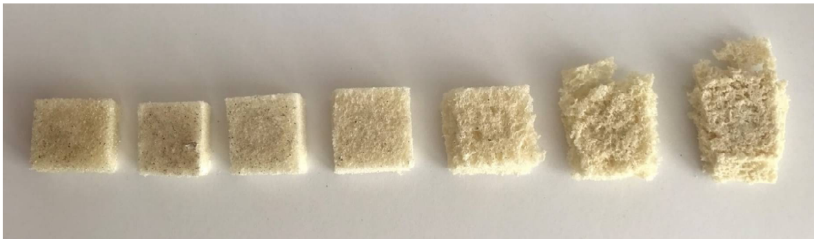
Рис. 3. Зовнішній вигляд стиснених зразків ППУ, модифікованих силіконом
