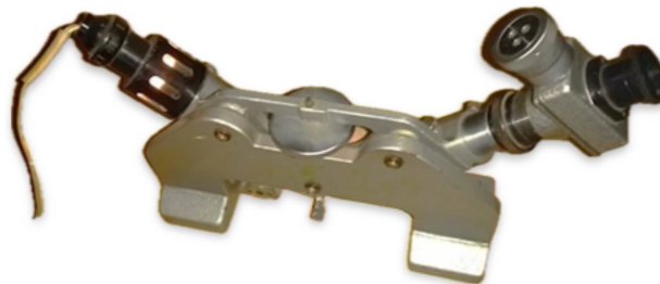
Рис. 4 Вимірювання шорсткості шпону за допомогою мікроскопа ТСП 4
