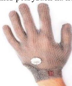
Рис. 2. Кольчужна рукавичка для роботи з ріжучим інструментом
