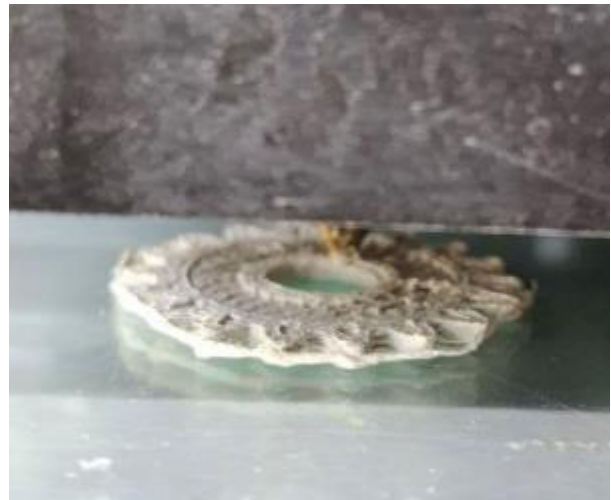
Рис. 4. Процес друку шестерні на 3Д принтері MALYAN Desktop 3D Printer
