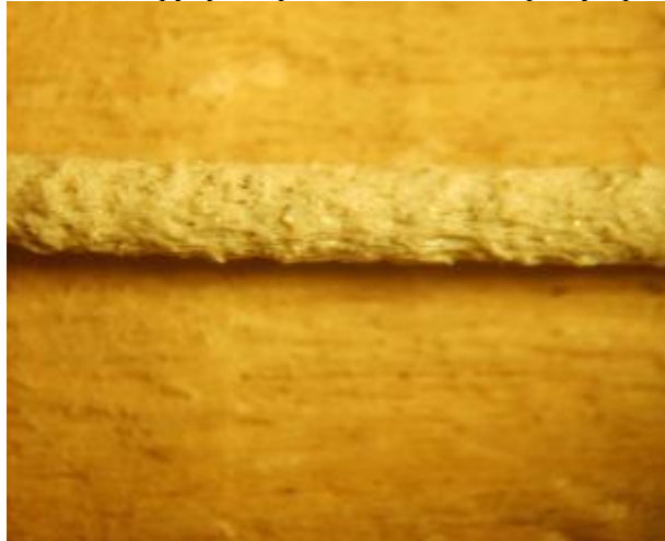
Рис. 2. Філамент після першого екструдювання на echo extruder: а – загальний вид (x14), б – злам полімер-базальтового композиту (x28)
