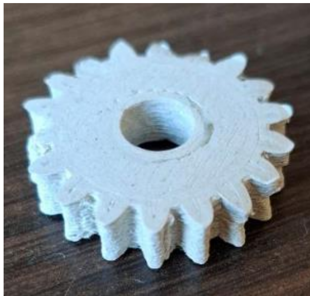
Рис. 5. Шестерня надрукована на 3Д принтері MALYAN Desktop 3D Printer
