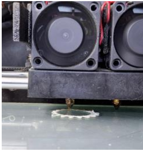
Рис. 4. Процес друку шестерні на 3Д принтері MALYAN Desktop 3D Printer
