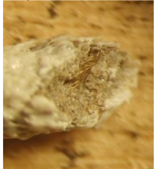
Рис. 2. Філамент після першого екструдювання на echo extruder: а – загальний вид (x14), б – злам полімер-базальтового композиту (x28)
