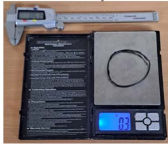
Рис.17. Монітка надрукована з подрібнених часток ABS пластику на 3D-принтері з шнековим екструдером
