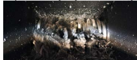
Рис.5. Подрібнення пластику ABS ножами шредера: а-куски матеріалу в бункері; б-захоплення кусків матеріалу ножами
