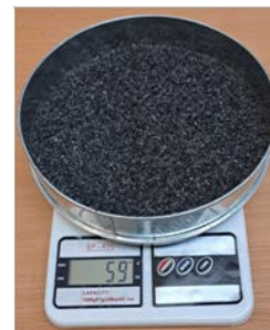
Рис.8. Визначення маси фракції матеріалу на ситі
