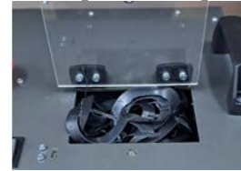
Рис.3. Завантажувальний бункер з полімерними відходами
