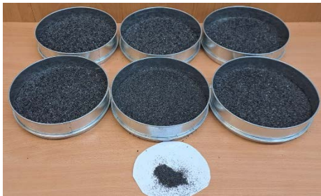
Рис.9. Розподілені по фракціях подрібнені частки після просіювання
