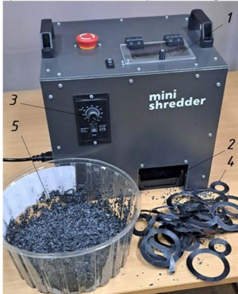
Рис.2. Міні шредер для подрібнення полімерних відходів: 1-завантажувальний бункер; 2-контейнер для подрібнених часток полімеру; 3-регулятор частоти обертання подрібнюючого органу; 4-полімерний матеріал, що подрібнюється; 5-подрібнені частки полімеру
