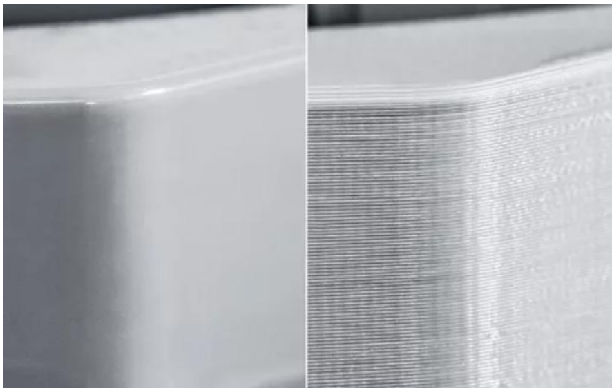
Рис. 4. Результат обробки пластику дихлоретаном
