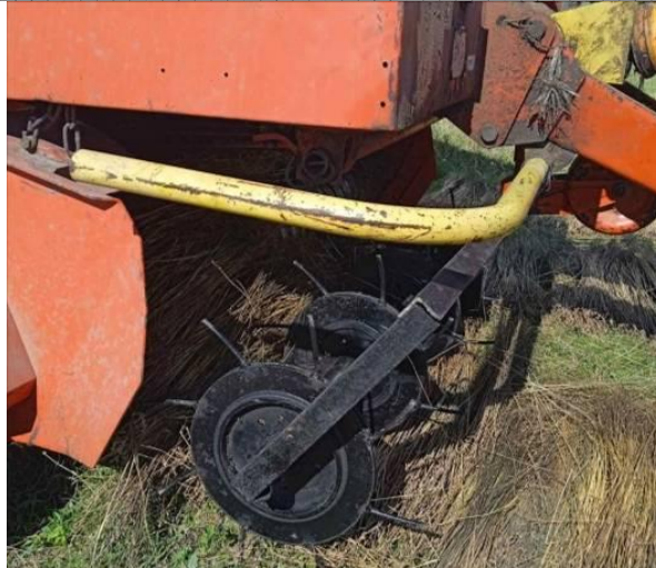
Рис. 1. Фото комбінованого підбирального апарата, яким обладнаний рулонний прес-підбирач для збирання стрічки льону
