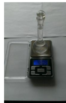
Рис. 3. Зважування пікнометра з рідиною та зразком
