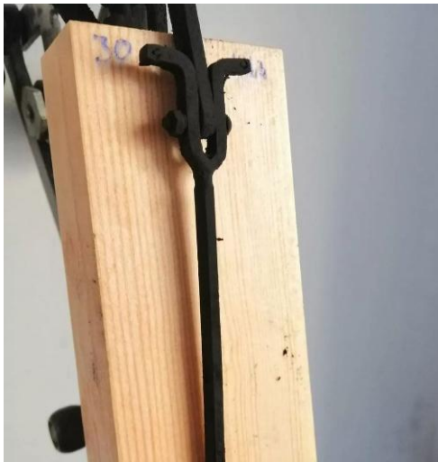
Рис. 2. Зразок перед вогневим випробуванням
