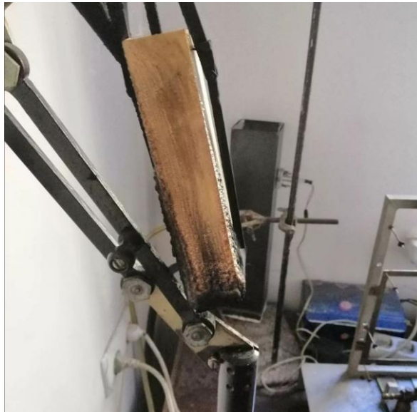
Рис. 1. Установка ОТМ для проведення випробувань
