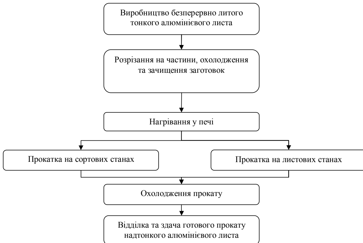
Рис. 2. Загальна схема реалізації технології безперервного лиття-прокату надтонкого алюмінієвого листа
