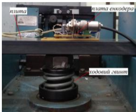
Рис.6. Кріплення магнітних енкодерів до машини:
