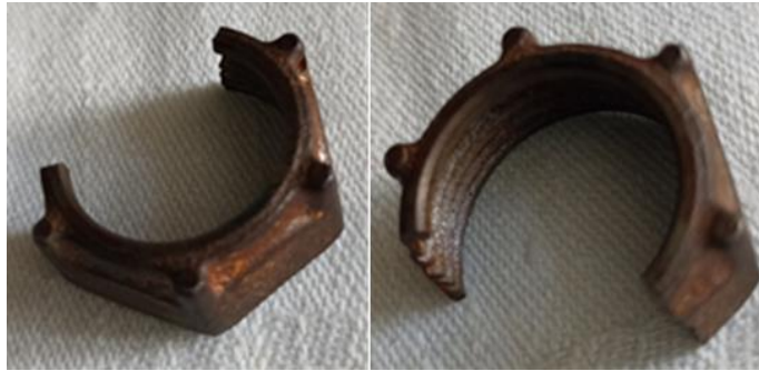
Рис.1. Деталь «Гайка» з слідами корозії після випробувань в кліматичній камері
