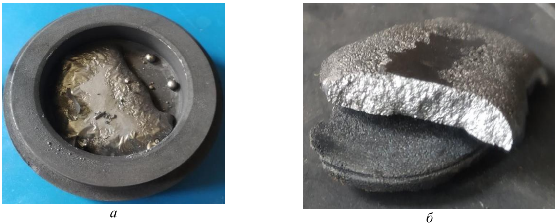
Рис. 2. Зовнішній вигляд зливка з плівкою на поверхні (а) та без неї (б)
