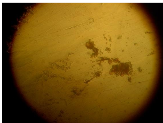
Рис. 2. Неметалічні включення в робочому шарі верху бочки валка до (а) та після (б) обробки азотом, ×1000
