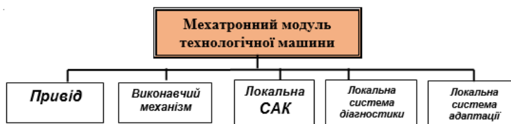
Рис. 1. Структура розвинуеного мехатронного модуля технологічної машини
