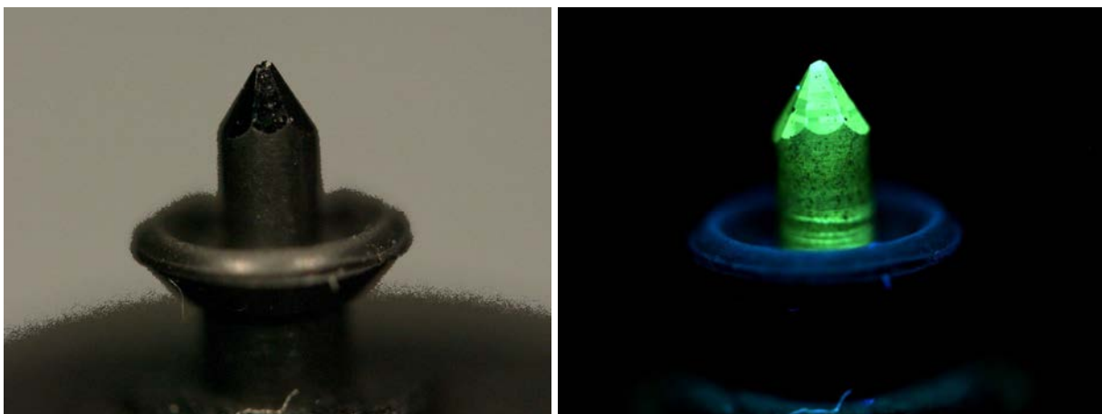
Рис. 3. Зображення і фотолюмінесцентне світіння алмазної заготовки для вістря СТМ
