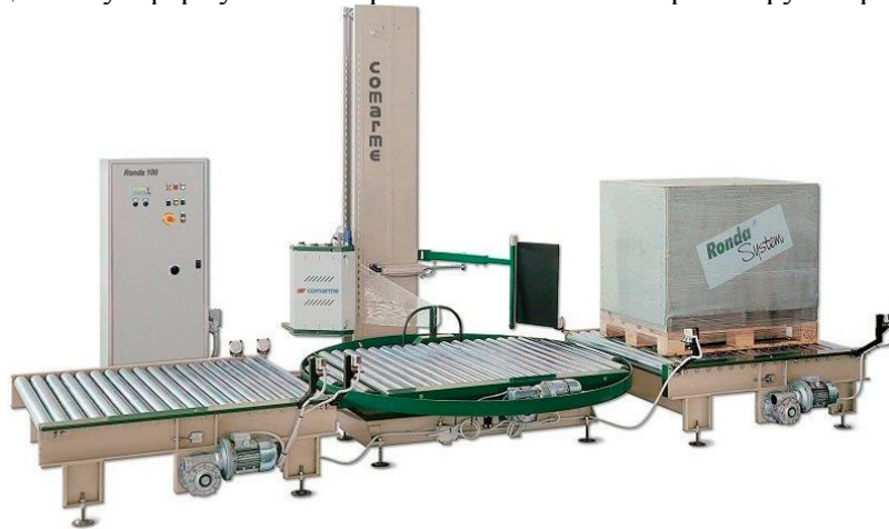
Рис. 2. Лінія великогабаритного групового пакування у стрейч-плівку на основі піддона
