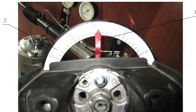
Рис. 3. Люфтомір: 1 – стрілка; 2 – шкала
