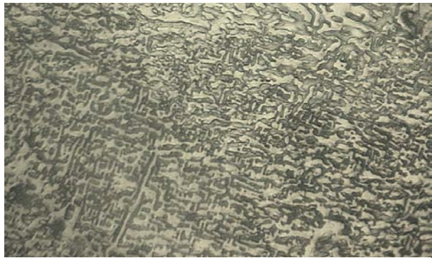
Рис. 10. Мікроструктура сплаву ЖС26-ВИ (x1600)
