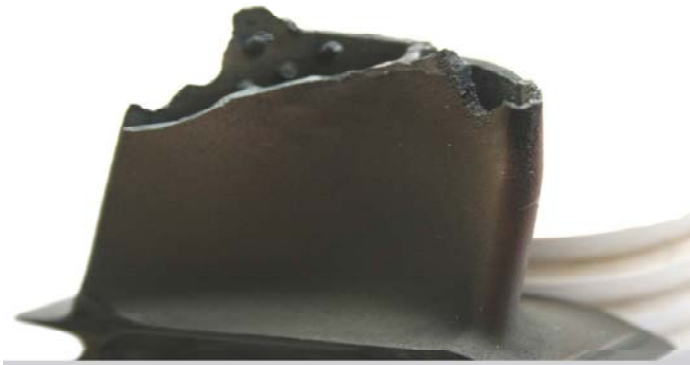
Рис. 3. Розтріскування поверхні лопатки №1 поблизу зламу (x25)
