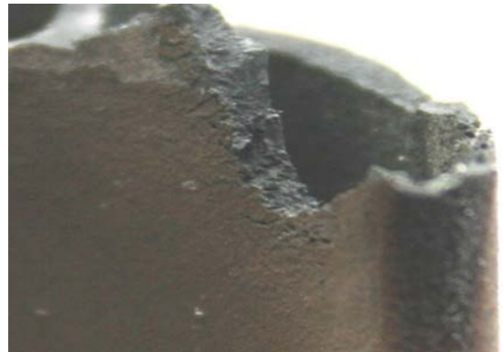
Рис. 4. Сліди обгорання покриття вхідної кромки лопатки №1 (x25)
