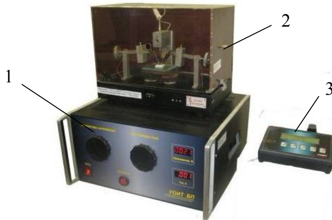
Рис. 1. Загальний вигляд автоматизованої установки для випробувань діелектричних матеріалів на трекінгостійкість: 1 – блок живлення та автоматичних вимірювань; 2 – камера для встановлення зразків; 3 – дистанційний блок керування установкою
