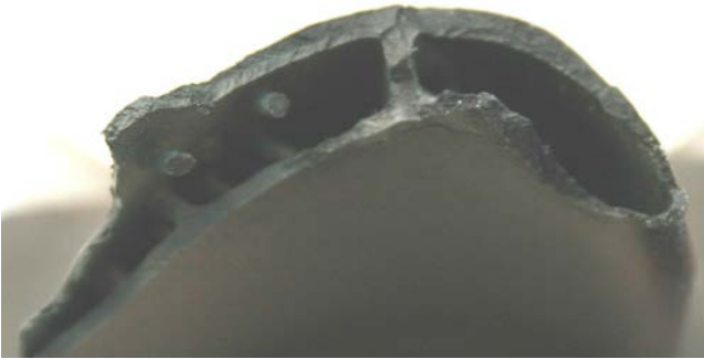
Рис. 7. Втомний злам лопатки №1 (x25)
