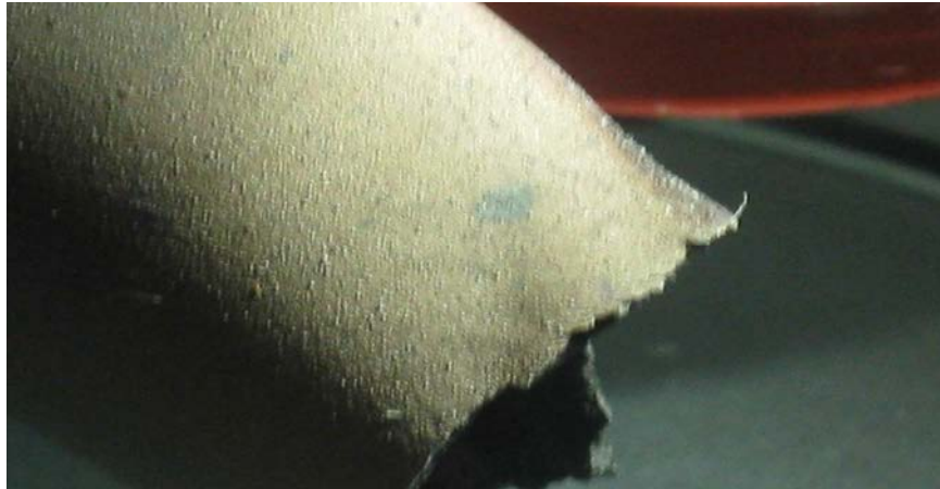
Рис. 19. Вмятина з наступним виходом на злам
