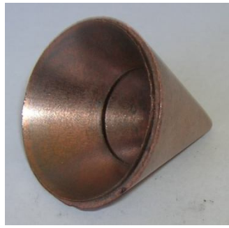
Рис. 1. Прессованная порошковая облицовка
