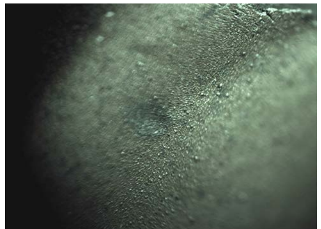
Рис. 6. Слід від удару з пошкодженням покриття (x25)
