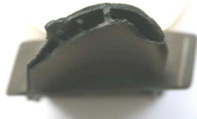
Рис. 2. Злам лопатки №2 за місцем руйнування (x25)
