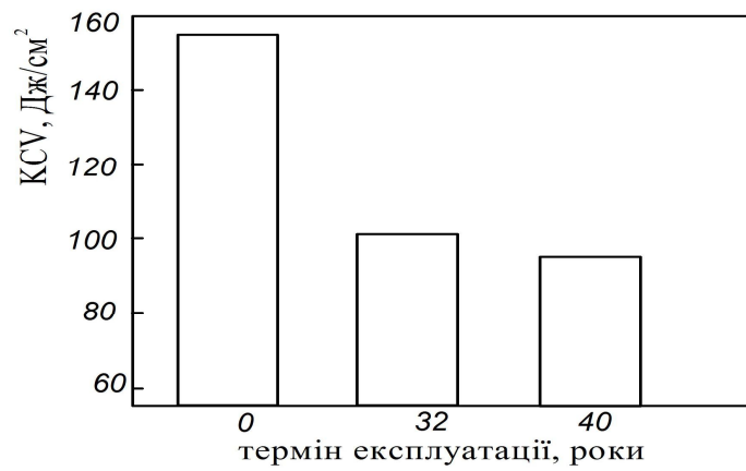
Рис. 2. Вплив терміну експлуатації резервуара РВС– 1000.№1 на ударну в'язкість сталі 3 сп
