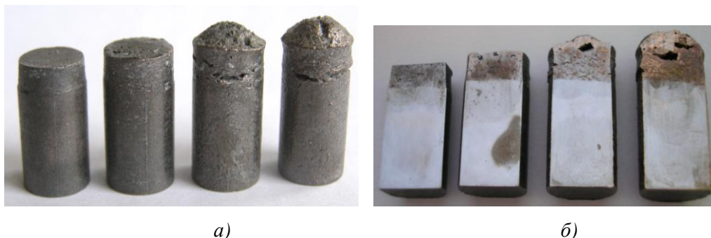
Рис. 2. Внешний вид (а) и вид вертикальных разрезов (б) образцов, пропитанных возрастающим количеством латуни (1 – 4 г)
