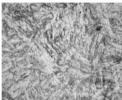
Рис. 2. Микроструктура металла лопатки после объемной термической обработки
