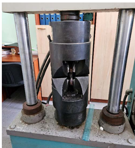
Рис. 5. Проведення експериментальних досліджень механічних властивостей зразків із сірого чавуну на стенді МР-100
