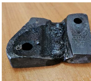
Рис. 4. Зразки заготовок, які виготовлені із сірого чавуну зварені різними електродами: а – ЦЧ-4; б – МНЧ-2; в – УТР 8
