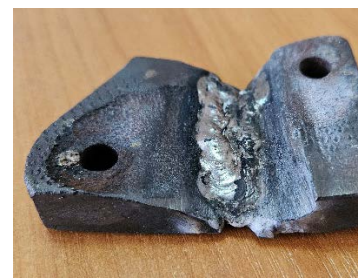
Рис. 4. Зразки заготовок, які виготовлені із сірого чавуну зварені різними електродами: а – ЦЧ-4; б – МНЧ-2; в – УТР 8
