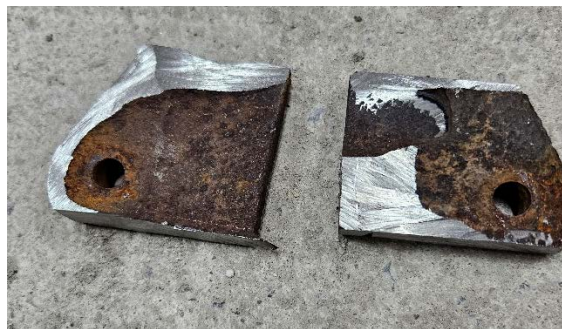
Рис. 2. Заготовки вирізані із випускного колектора двигуна автомобіля
