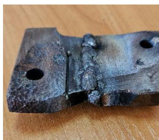
Рис. 4. Зразки заготовок, які виготовлені із сірого чавуну зварені різними електродами: а – ЦЧ-4; б – МНЧ-2; в – УТР 8
