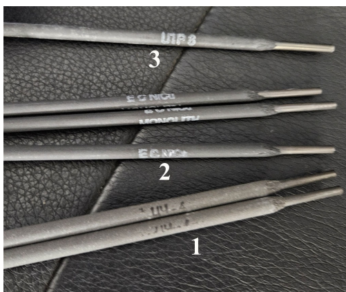
Рис. 3. Зварювальні електроди, які використовувалися в експерименті: 1 – ЦЧ-4; 2 – МНЧ-2; 3 – УТР 8
