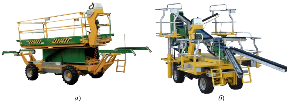
Рис. 3. Самохідні садові платформи Zip 30 фірми Blosi: а) – для детального обрізування крон плодових дерев; б) – для збиранні плодів
