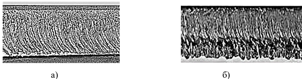
Рис. 4. Фото поверхні різів в нержавіючій сталі товщиною 5 мм: різ при використанні азоту як робочого газу (а), різ при піддуванні стисненого повітря (б)
