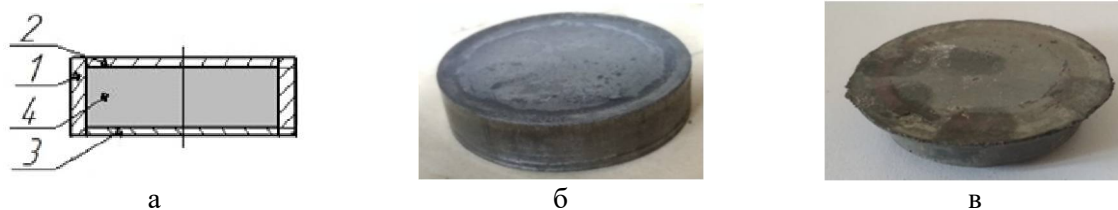
Рис. 2. Схематичне зображення вихідної заготовки (а), а також зразок до (б) та після деформування (в): 1 – сталеві обойми, 2 – верхня кришка; 3 – нижня кришка; 4 – досліджуваний матеріал
