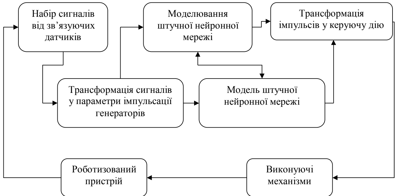
Рис. 2. Планування поведінки роботизованого пристрою на базі керуючих автоматів
