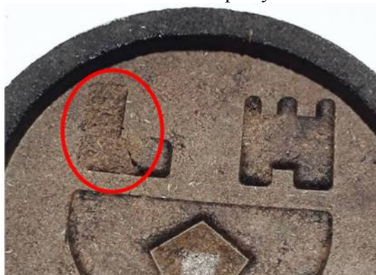
Рис. 5. Дефектний вигляд виробу із ділянкою руйнування виступаючого елемента
