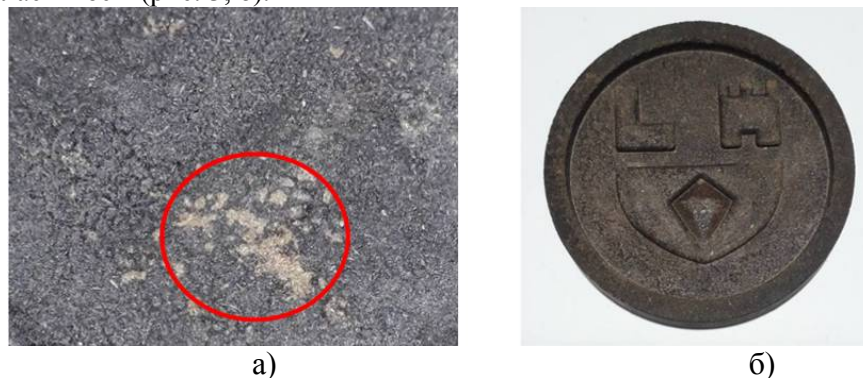
Рис. 3. Вигляд виробу з дефектами: а – зона відшаровування; б – ліофобна поверхня біокомпозитного виробу
