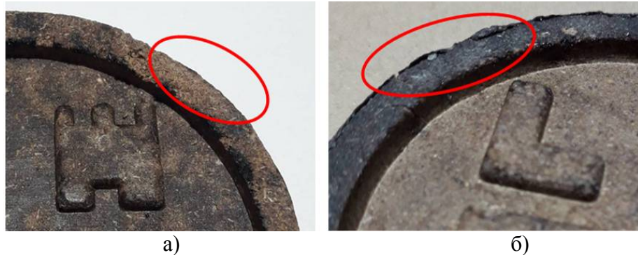
Рис. 2. Вигляд виробу з дефектами: а – зона викришування; б – зона облою
