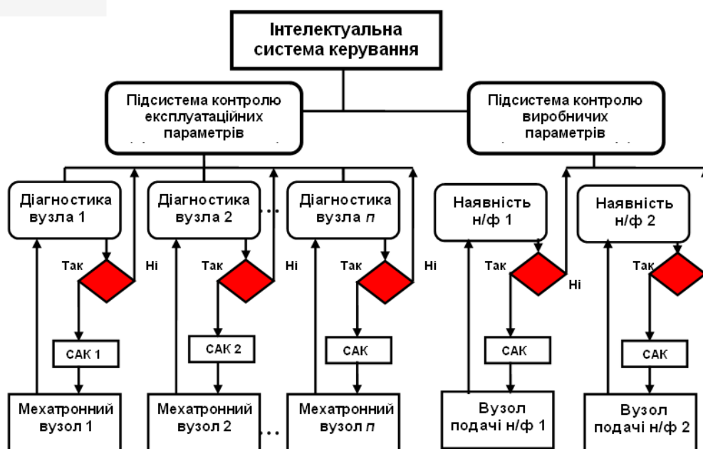
Рис.1. Структура технологічної машини з системою автоматичного керування і діагностування
