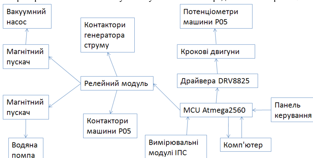
Рис.2. Структурна схема системи керування ІПС
