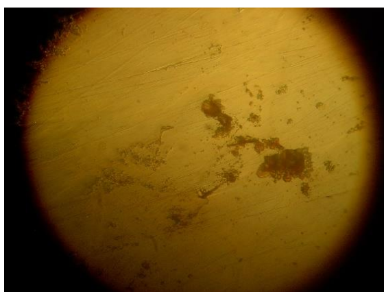
Рис. 2. Неметалічні включення в робочому шарі верху бочки валка до (а) та після (б) обробки азотом, ×1000
